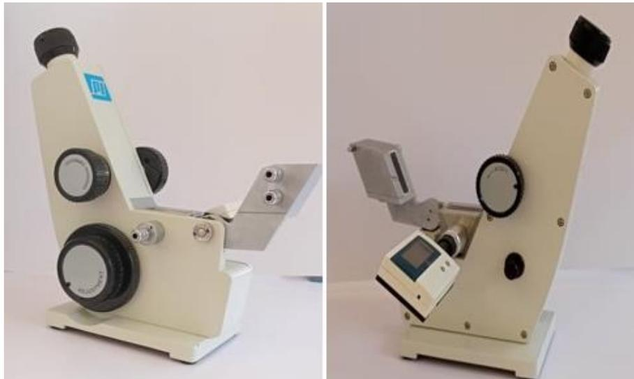
Figure III.7 : Réfractomètre d'Abbe
