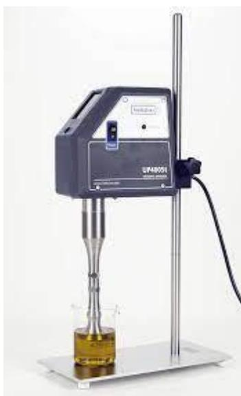
**Figure I.9 :** Extraction par ultrasons
