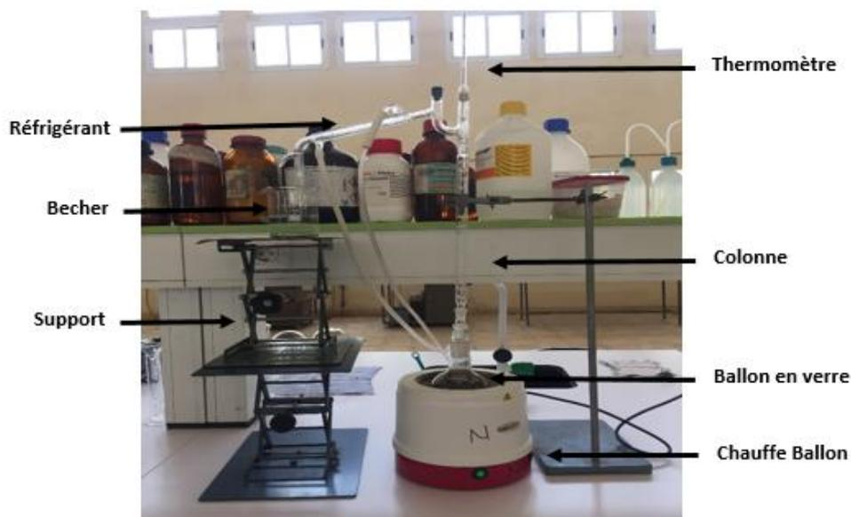
**Figure III.2 :** Montage d'hydrodistillation du tube simple.
