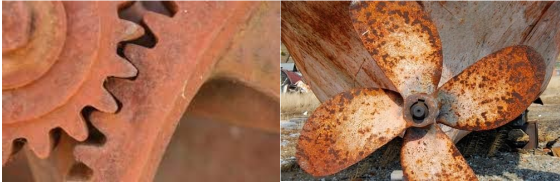
Figure I.1 : Photos de matériaux soumis aux phénomènes de corrosion [5,6].
