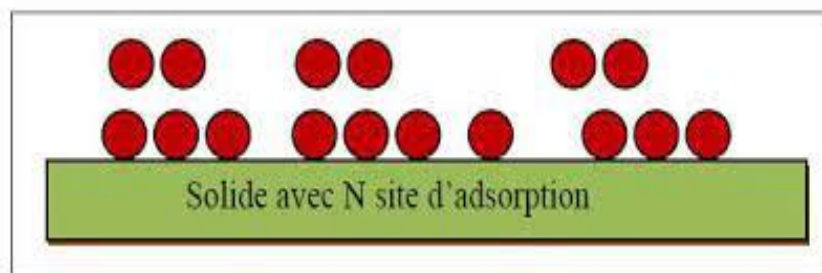
Figure II.6: Modèle d'adsorption en multicouches [18]
