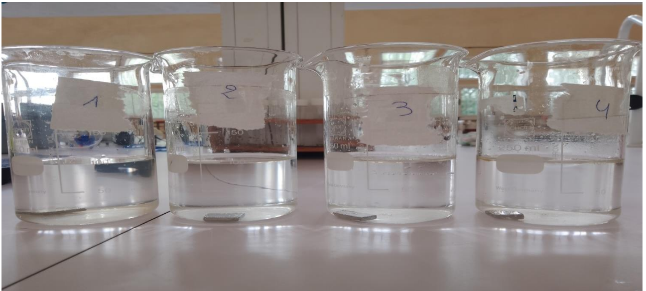
Figure IV.14: Schéma montrant l'essai de corrosion.
