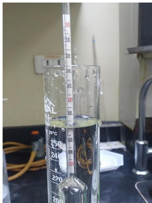
Figure III.10b. Mesure de la densité de l'aMDEA.
