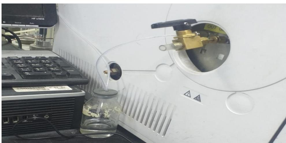
*Figure III.4. Injecteur de CPG (Laboratoire d'analyse de GLI/K (Skikda)).*
