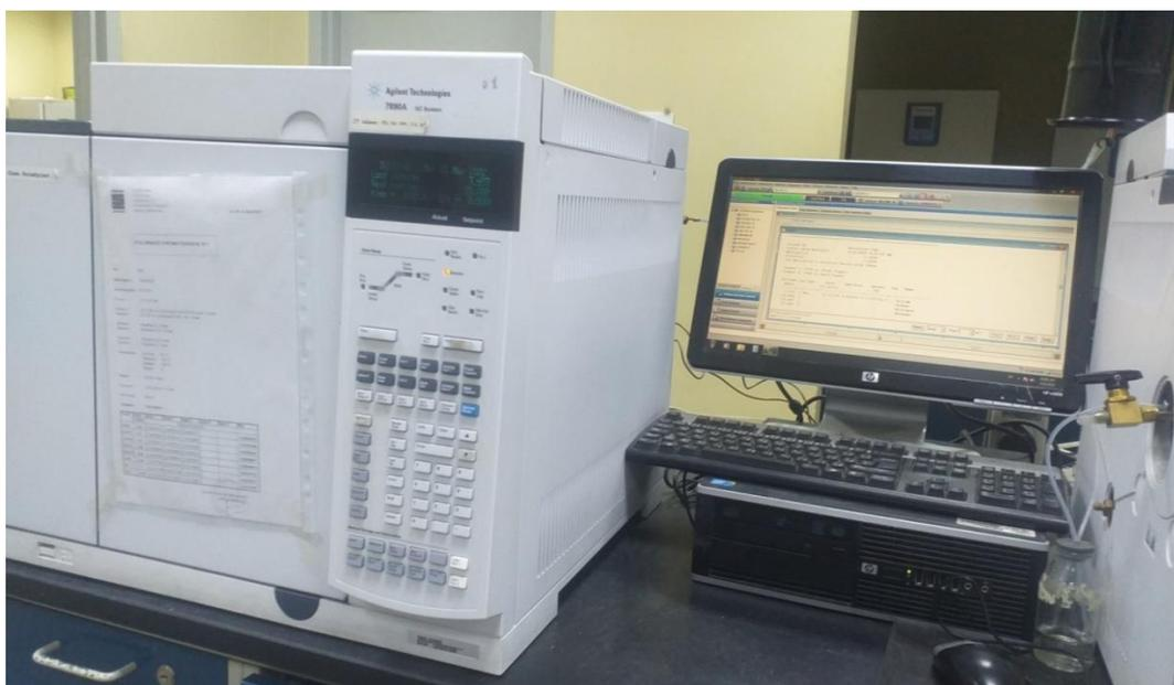
**Figure III.9.** Appareil CPG (Agilent, série US 10431051) utilisé (Laboratoire d'analyse de GLI/K).
