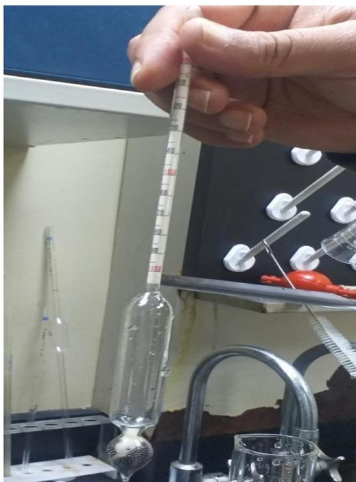
Figure III.10a. Densimètre utilisé.
