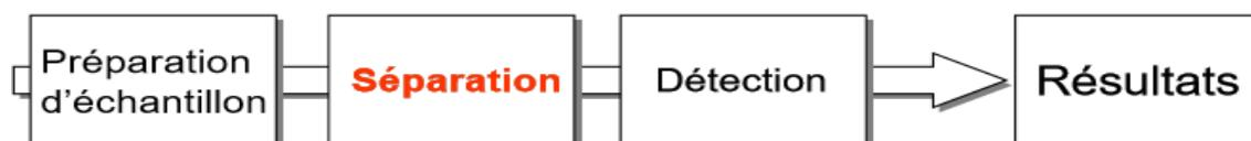
Figure III.8. Processus analytique de la chromatographie.
