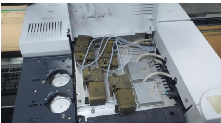
Figure III.6b. Détecteur(TCD) de CPG (Laboratoire d'analyse de GLI/K).
