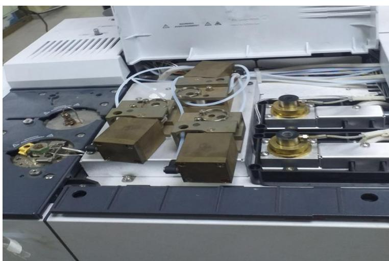
Figure III.6a. Détecteur (FID) de CPG (Laboratoire d'analyse de GL1/K).
