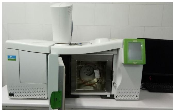
*Figure III.12* : Appareil de CPG.
