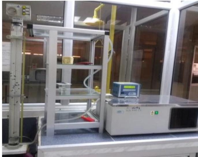
**Figure III.8** : Dispositif pour la mesure de la densité.
