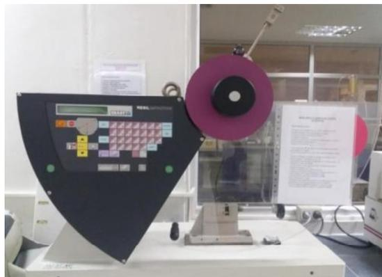
*Figure III.10* : Schéma d'un Mouton-pendule pour l'essai IZOD.
