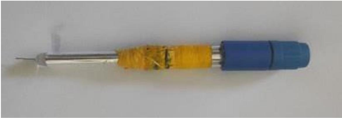
**Figure III.5 :** L'électrode auxiliaire
