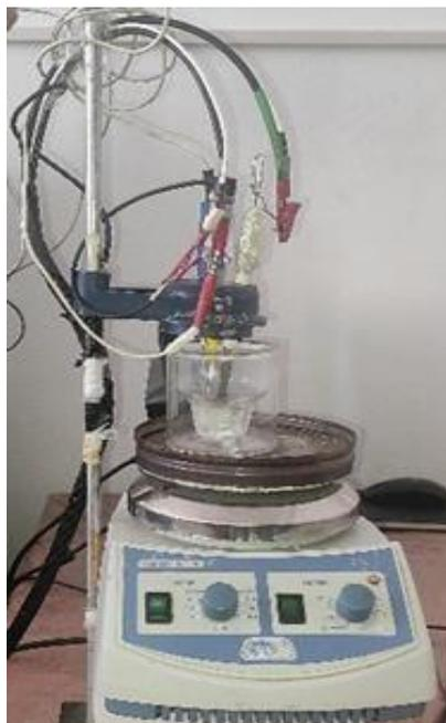
**Figure III.2 :** La cellule électrochimique
