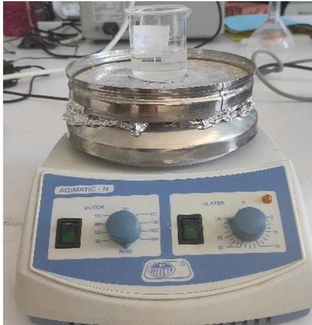
**Figure III.7 :** Agitateur magnétique à plaque chauffante
