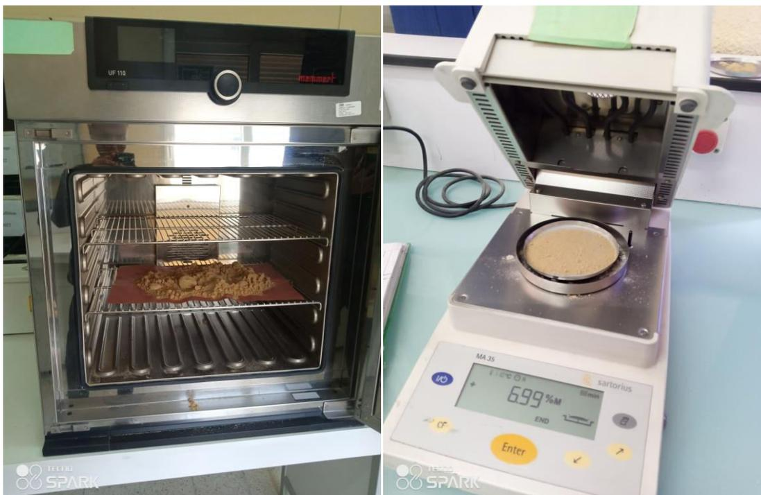
**Figure III.2 :** Les étapes de détermination le taux d'humidité.
