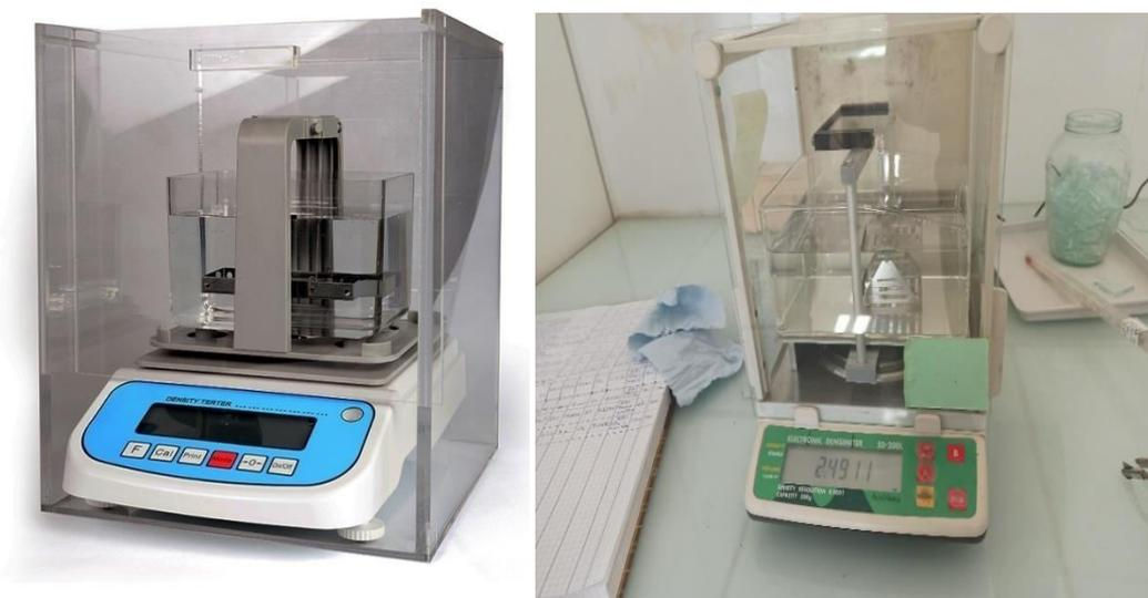
**Figure III.4 :** Mesure de la densité
