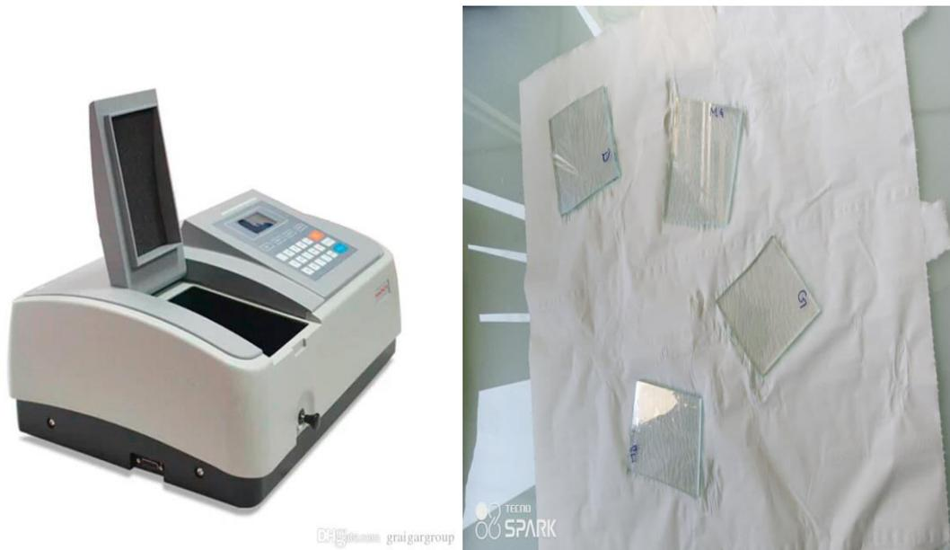
**Figure IV.4 :** Insertion de l'échantillon dans le spectromètre
