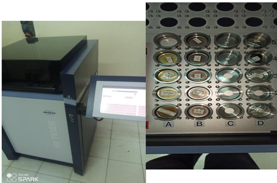
**Figure III.3. :** Spectromètre d'analyse de fluorescence de rayon X à MFG
