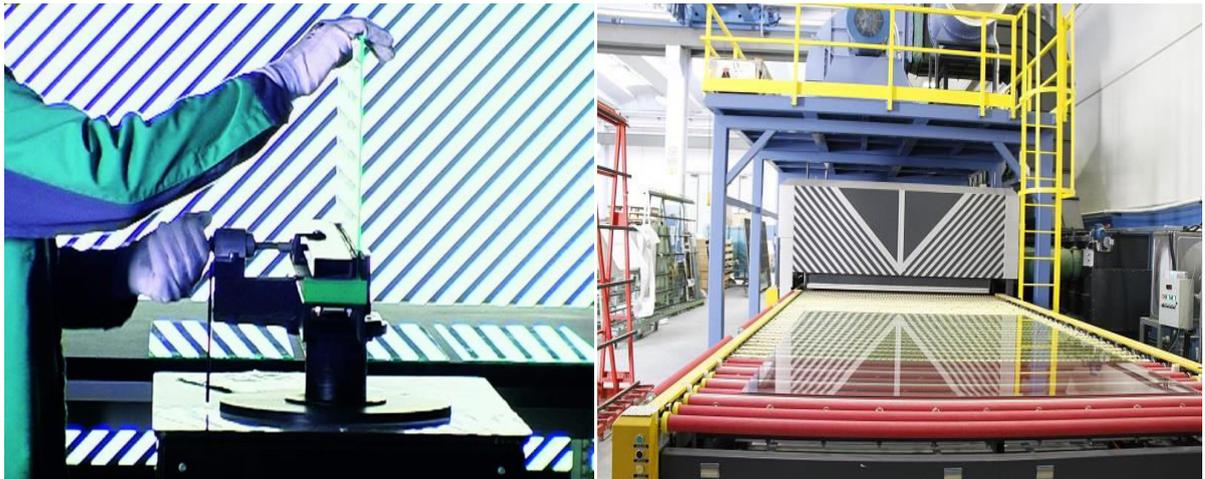
**Figure II.29 :** Le test zébra
