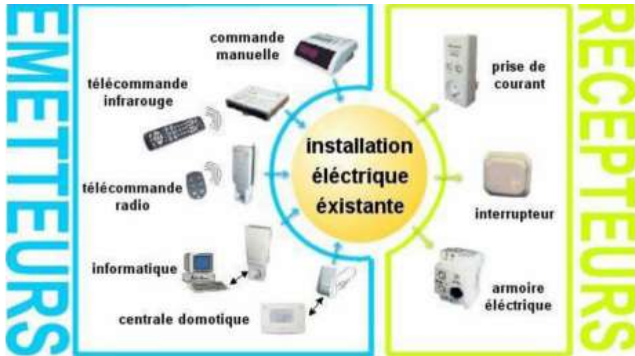
Figures 8 : Présentation de la technologie du courant porteur en ligne Source : Mémoire de fin d'étude
