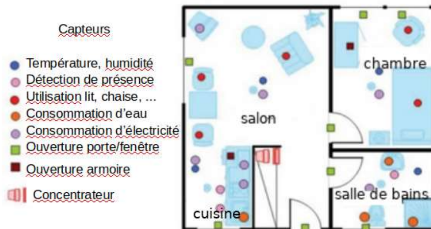
FIGURE 32 : Plan montrant le positionnement des capteurs
