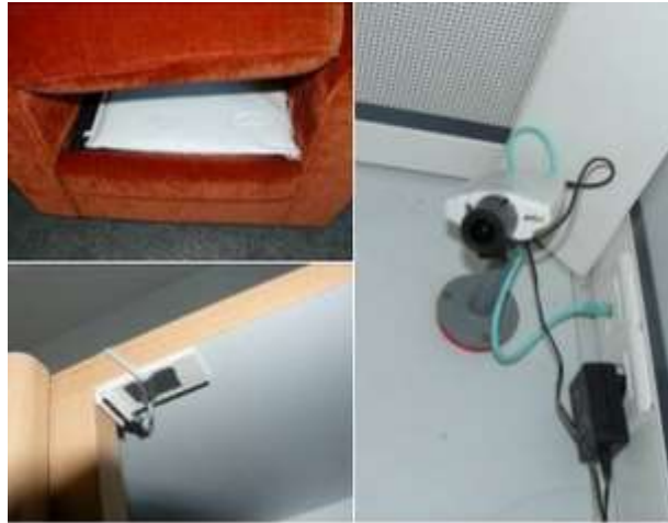
Figure33- GERHOME - instrumentation de l'habitat : capteurs, caméra et concentrateur Source : (Zouba et coll., 2009)
