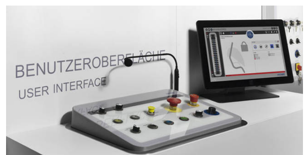
Figure 26: système de commande du téléphérique
