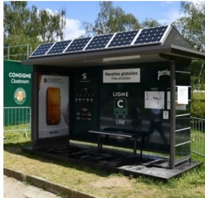
Figure 84: Ces abribus solaires autonomes
