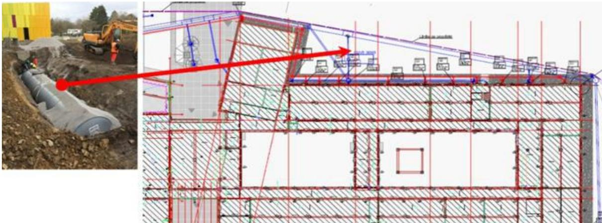
Figure 26: bache à eaux pour la récupération d'EP (30 m<sup>3</sup>)
