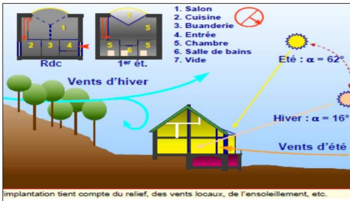
Figure 24 : L'implantation tient compte du relief, des vents locaux, de l'ensoleillement... (Source : livre Traité d'Architecture et d'Urbanisme Bioclimatique ; Concevoir, édifier et aménager avec le développement durable, page 64)
