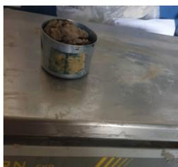
*Fig. 30 Détermination la teneur en eau naturelle*
