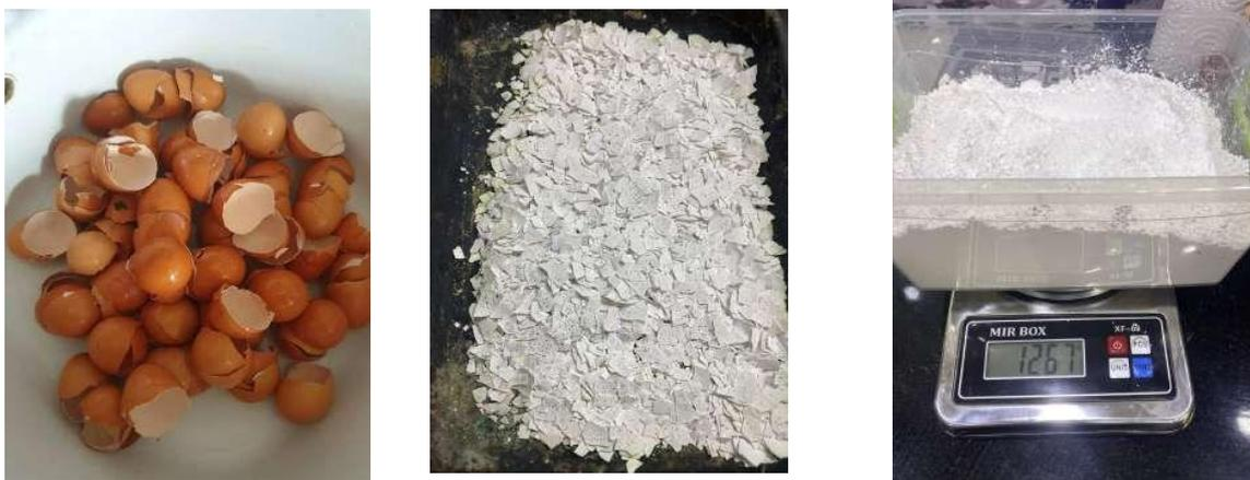
*Fig. 44 Coquille d'œuf avant et après calcination et après broyage*
