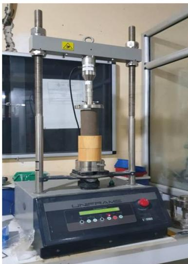
Fig. 47 Exécution de l'essai de compression
