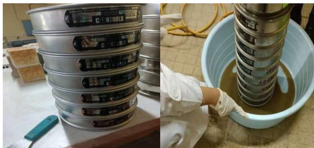
Fig. 31 Essai granulométrique par tamisage (voie humide)
