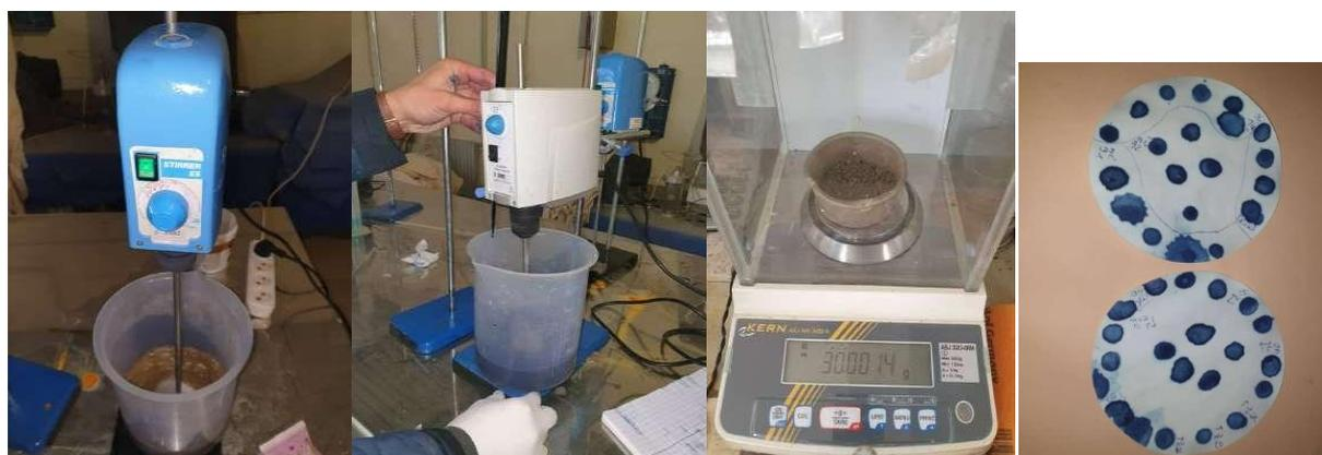
Fig. 38 Essai au bleu de méthylène
