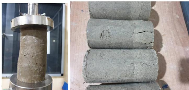
Fig. 48 Photos de l'écrasement de l'éprouvette de sol naturel
