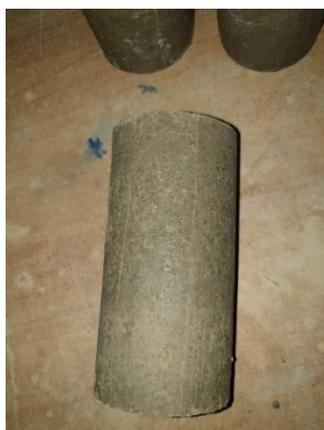
*Fig. 46 Photos de l'éprouvette après 28 jours*
