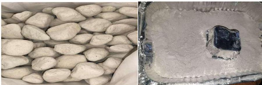
*Fig. 43 Zéolite avant et après broyage*
