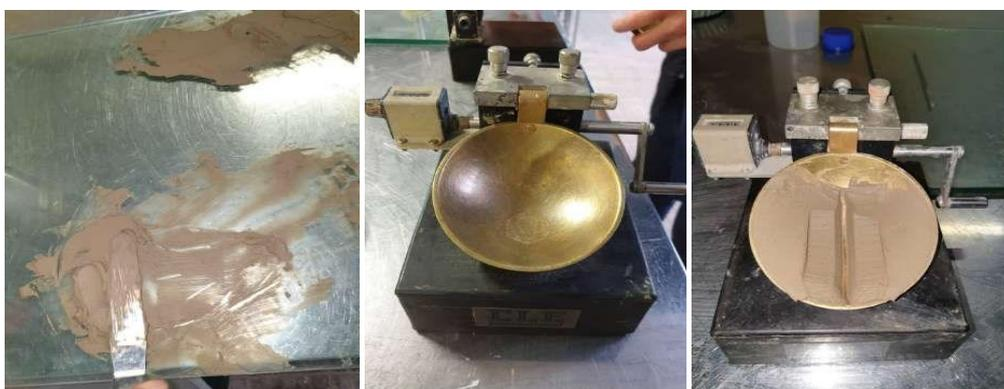
Fig. 35 Essai de détermination de la limite de liquidité par la coupelle de Casagrande
