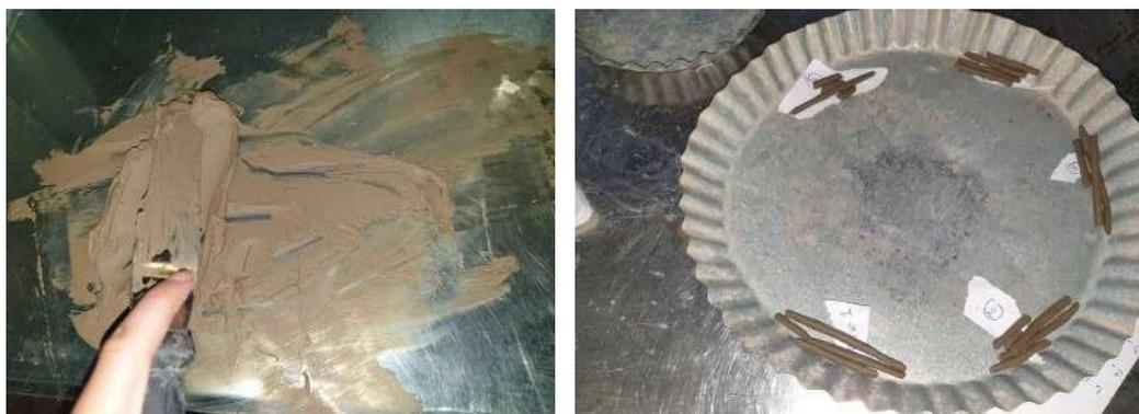
Fig. 37 Détermination de la limite de plasticité
