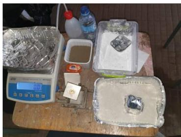
Fig. 53 Préparation des mélanges pour le compactage
