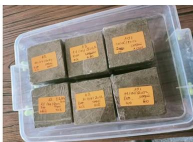
*Fig. 55 Les échantillons après la compression*
