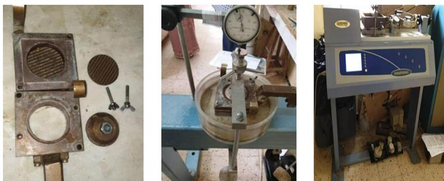
*Fig. 56 Cisaillement des éprouvettes dans la boîte de Casagrande*
