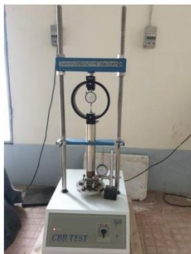
*Fig. 54 Compression avec l'appareil CBR*
