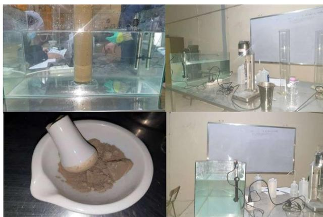
Fig. 33 Essai de granulométrie par sédimentation
