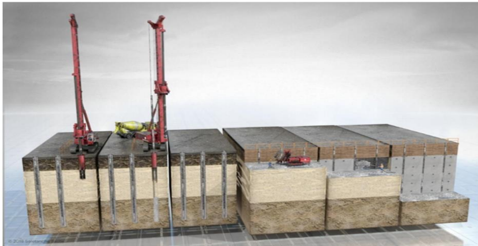
Figure I.20 : Schéma de la procédure d'exécution de la paroi berlinoise.
