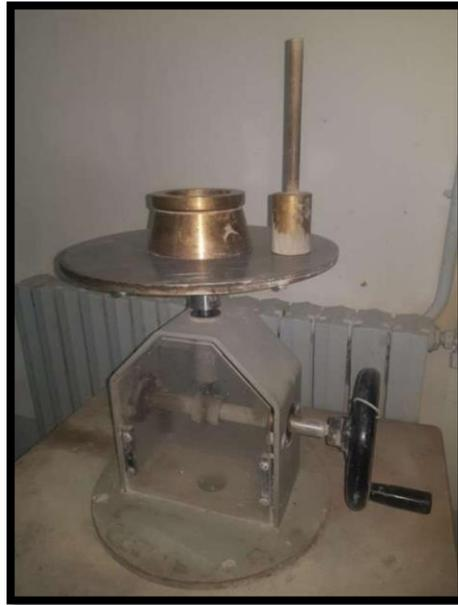
**Figure II.8.** Table à secousses (DGCH)
