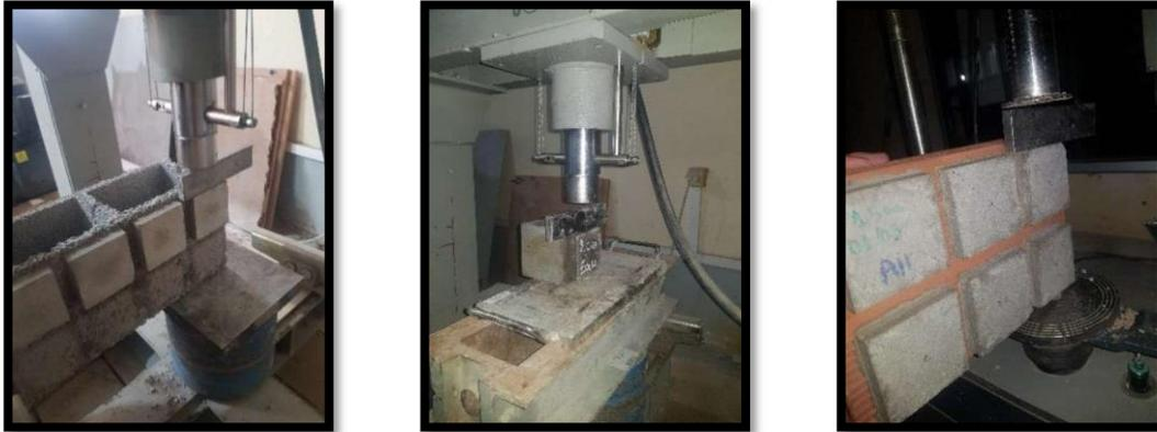
**Figure II.15.** Essai de cisaillement par compression
