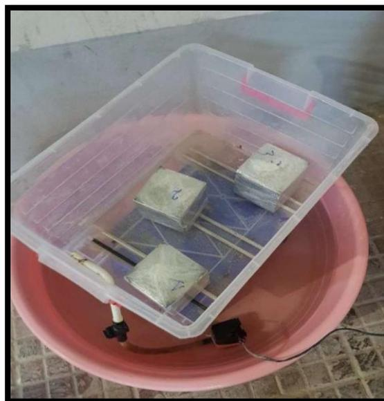
**Figure II.13.** Essai d'absorption pour béton
