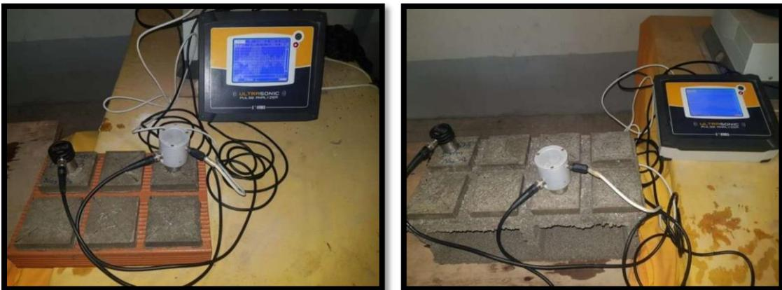
**Figure II.14.** Essais de mesure des vitesses ultrasoniques de surface
