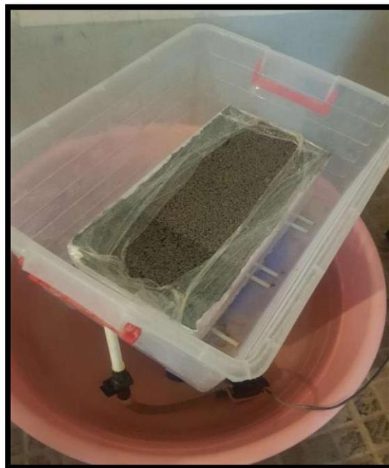
**Figure II.11.** Essai d'absorption pour parpaing.
