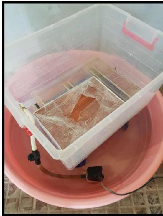
**Figure II.12.** Essai d'absorption pour brique.
