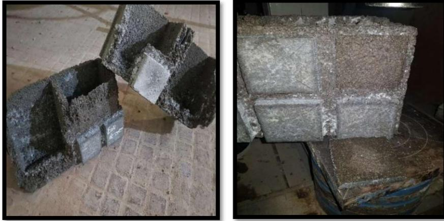
**Figure IV.21.** Modes de rupture du mortier revêtement sur support en parpaing
