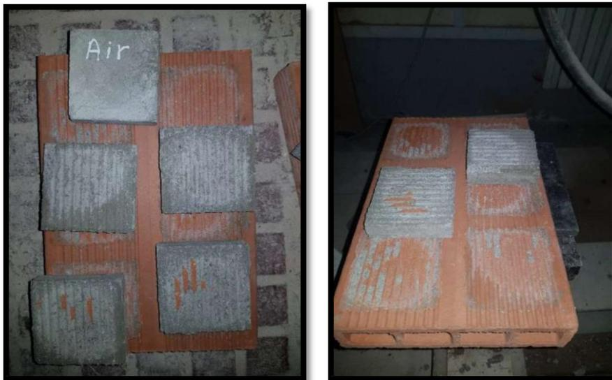
**Figure IV.22.** Mode de rupture du mortier sur revêtement sur support en brique
