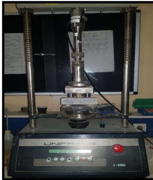
**Figure II.9.** Essai de flexion
