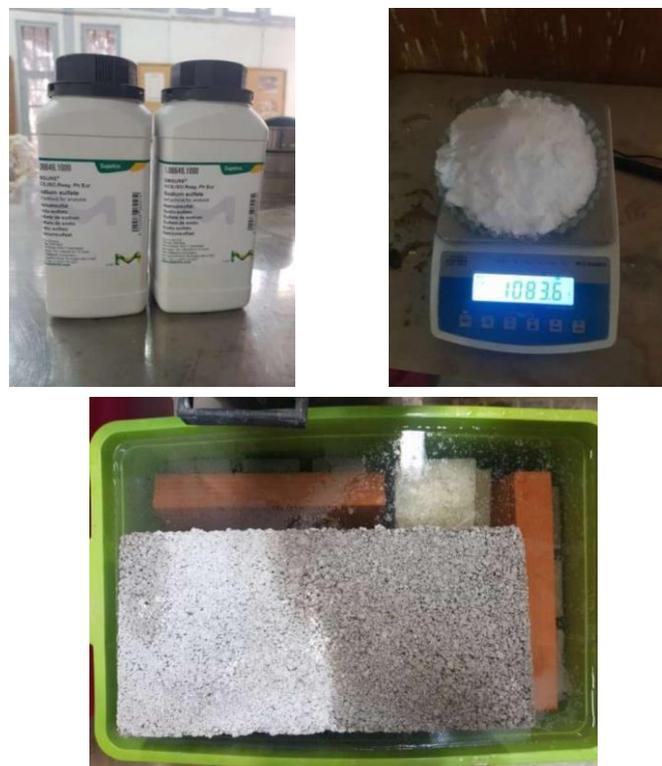
Figure II.7. Conservation des corps d'épreuve dans une solution de Na<sub>2</sub>SO<sub>4</sub> (5%)
