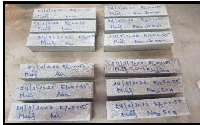
**Figure II.3.** Les échantillons de mortier
