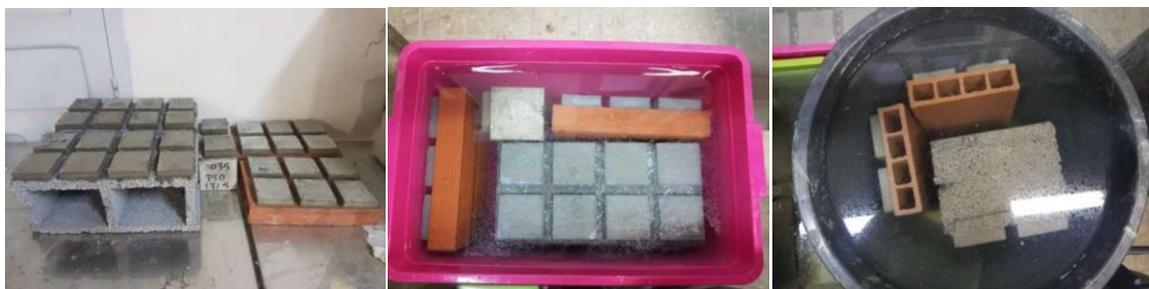
Figure II.6. Conservation des corps d'épreuve à l'air libre, dans l'eau de mer et dans l'eau
