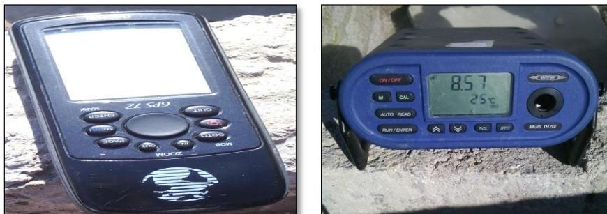
**Figure 14** : Un multi paramètre de type Multi 1970i et GPS (photos présent par Doghman ,Kemouquette et Selatnia, 2016).
