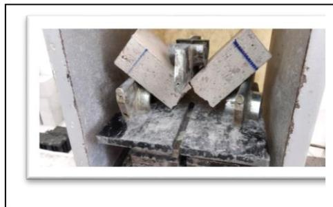
**Figure V.4 :** Mode de rupture en traction par flexion des éprouvettes.
