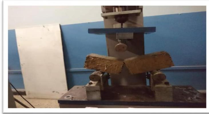
**Figure IV.16** : Essai de traction par flexion.
