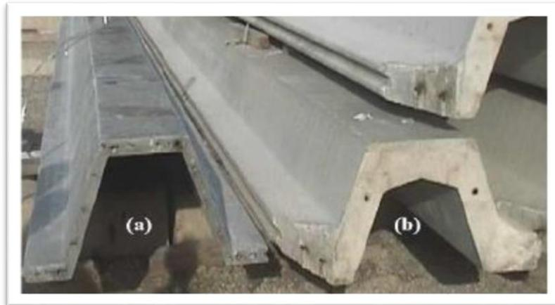
**Figure II.5:** Palplanches précontraintes à base de mortier autoplaçant fibré(a), béton armé ordinaire (b).
