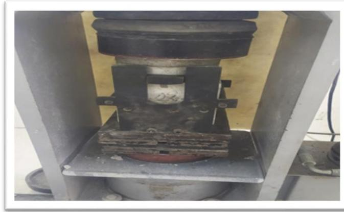
**Figure IV.17 :** Essai de traction par fendage.
