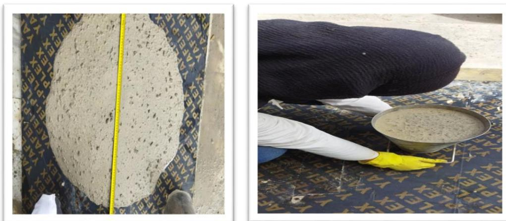
**Figure IV.9 :** Essai d'étalement utilisé.
