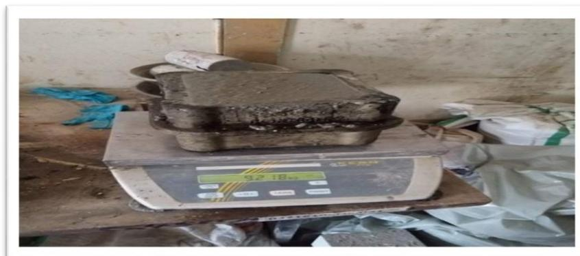
**Figure IV.14** : Mesure de la densité.
