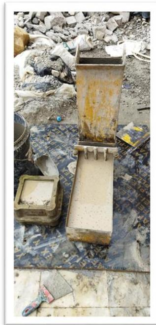
**Figure I.12:** Essai à la boîte en L utilisé.
