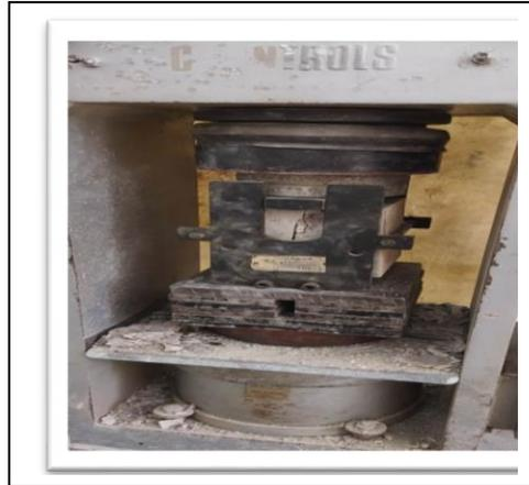
Figure V.7 : Mode de rupture en traction par fendage des éprouvettes.
