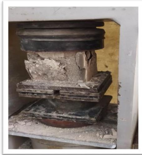
Figure V.1 : Mode de rupture des éprouvettes par la presse.
