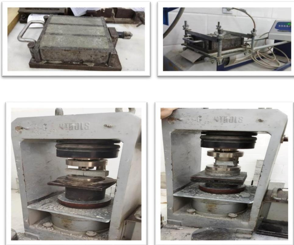
**Figure IV.5 :** Essais de traction par flexion et compression de ciment utilisé.
