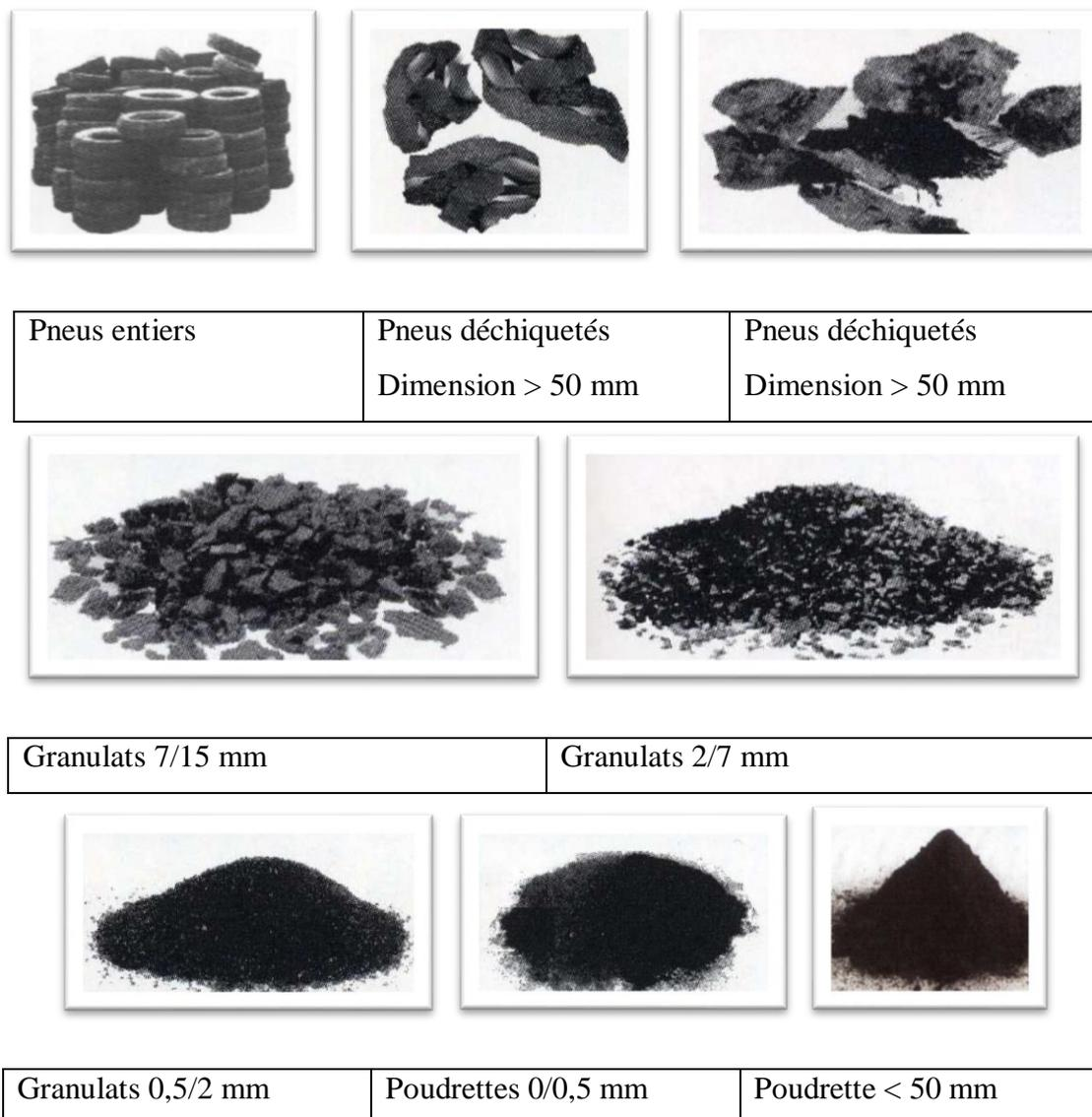
**Figure III.4 :** Schéma d'une filière de valorisation matière (Interstate 880/Dixon Landing Road, 2001).
