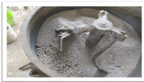
**Figure IV.7** : Le malaxeur utilisé.
