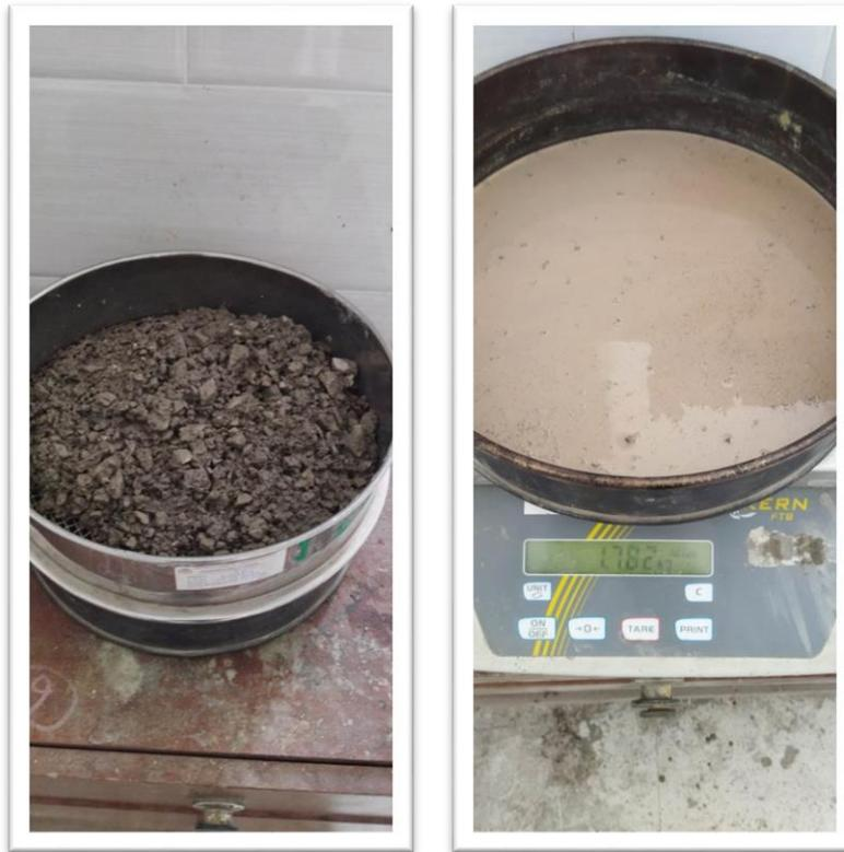
Figure I.13 : Essai de stabilité au tamis utilisé.
