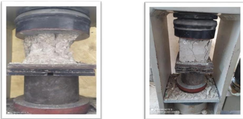
**Figure IV.15 :** Essai de compression par écrasement utilisé.
