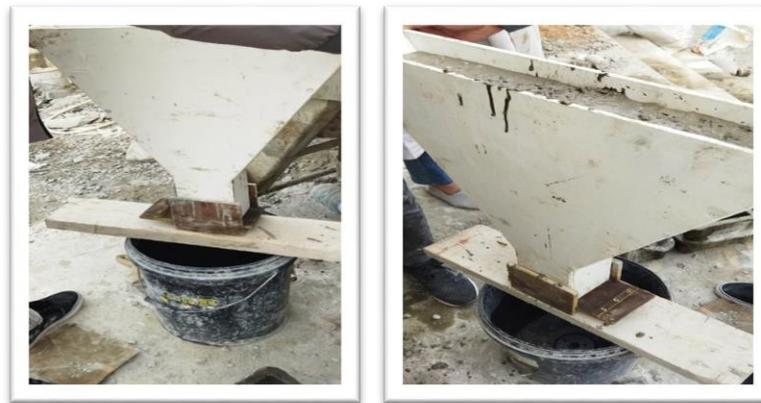
**Figure IV.13** : essai de l'entonnoir en V utilisé.
