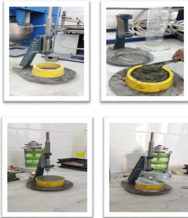
**Figure IV.4 :** Essai de consistance de ciment utilisé.
