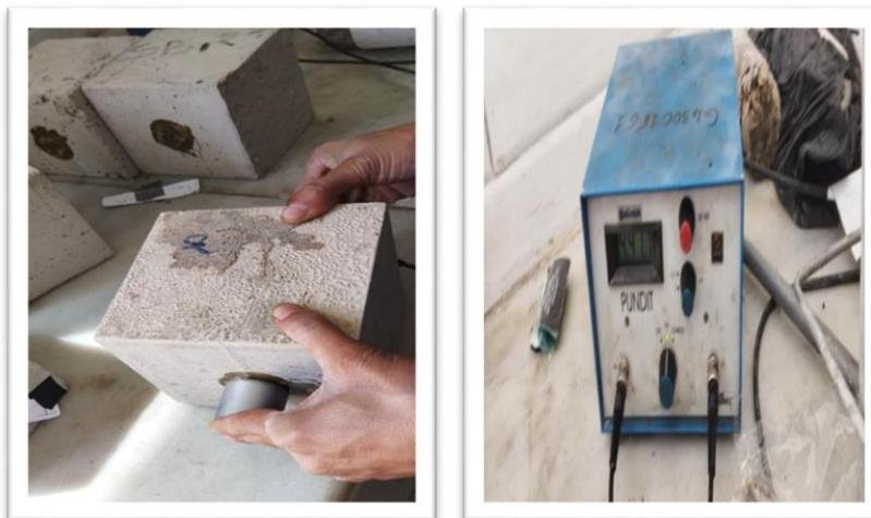
**Figure IV.19** : Essai ultrasonique utilisé.
