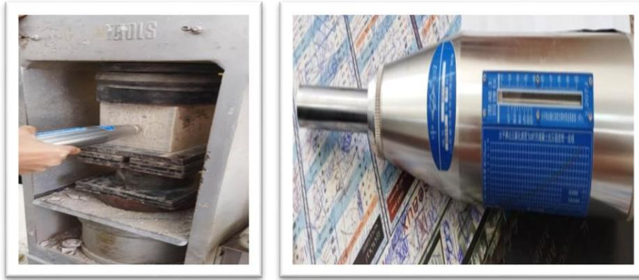
**Figure IV.18** : Essai au scléromètre utilisé.
