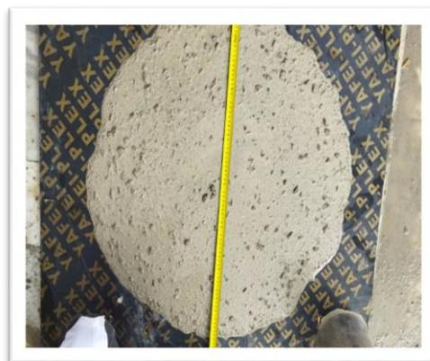
**Figure IV.10** : essai d'étalement du BAP d'étude utilisé.
