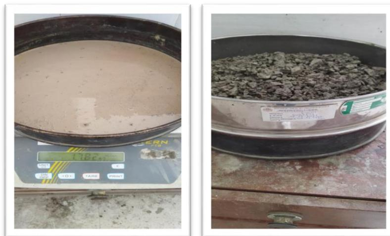
**Figure IV.12** : Essai de stabilité au tamis utilisé.
