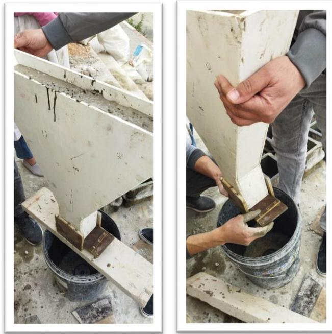
Figure I.11: L'essai d'écoulement au V-Funnel utilisé.
