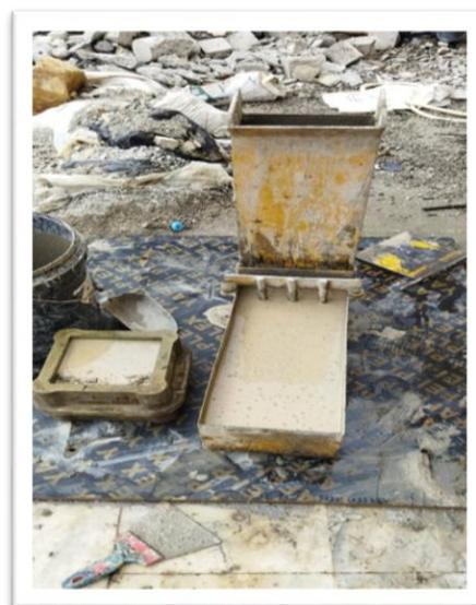
**Figure IV.11** : Essai d'écoulement à la boîte en L.
