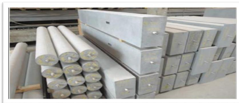
Figure I.4 : Eléments préfabriqués en BAP à haute résistance.
