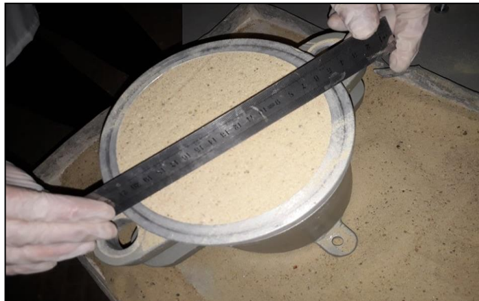
III.8: Détermination de la masse volumique sèche minimale.
