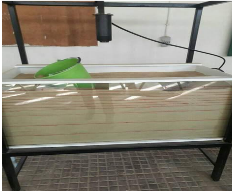
Figure IV.5: Technique de remplissage du box du modèle par le sable sur des couches de 10cm d'épaisseur.
