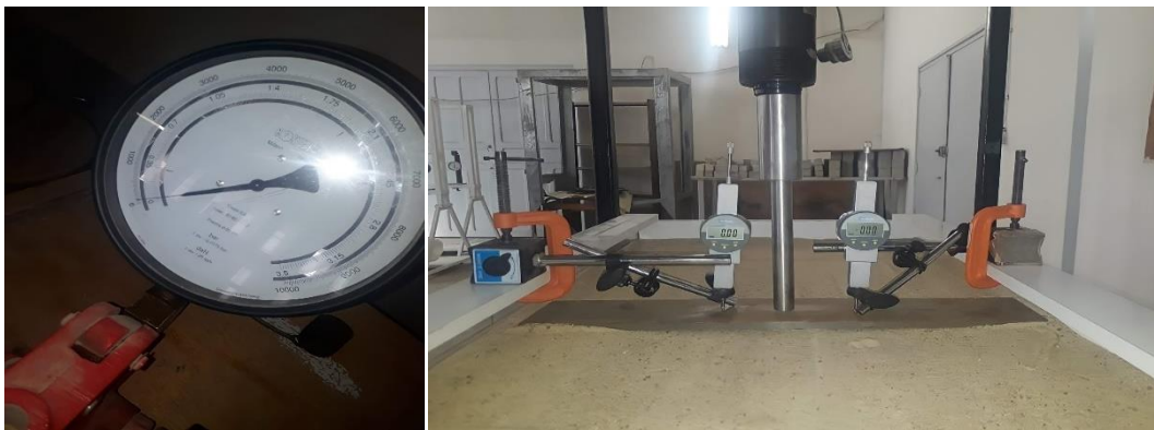
Figure IV.6: Dispositif de mesure des tassements et de la pression.
