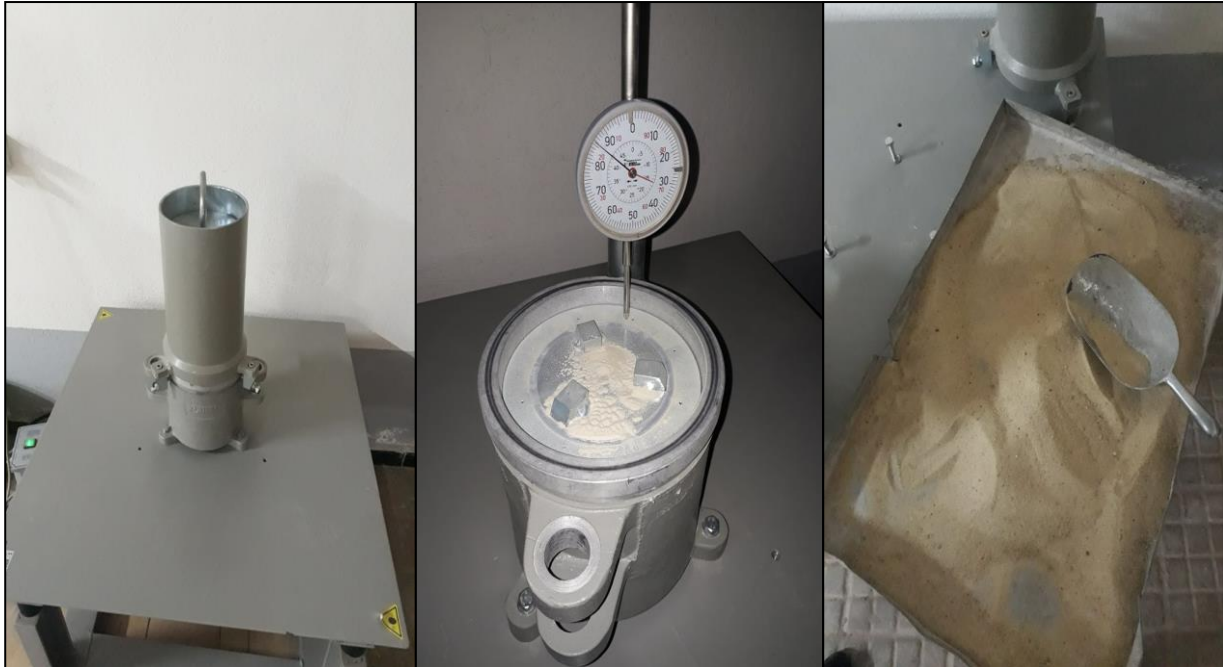
Figure III.9: Détermination de la masse volumique sèche maximale.
