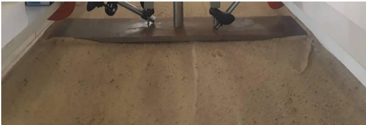
Figure IV.3: photo du modèle de semelle utilisée dans les essais.
