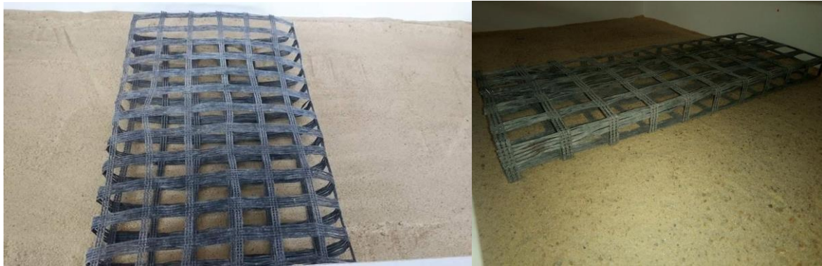
Figure IV.4: photos du géogrille utilisé dans les essais.
