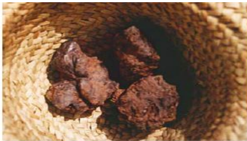
Figure3.46 Pierres de limonite composées d'oxydes de fer. [30]
