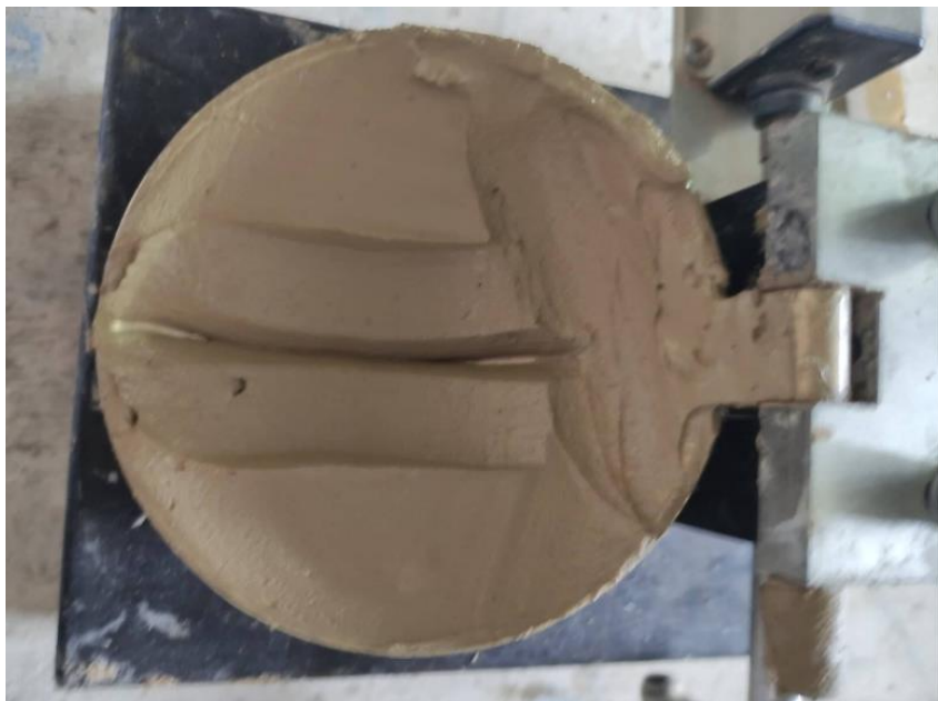
Figure 4.12 Sol se referme sur une longueur de 12 à 13 mm après être tombé 25 fois.
