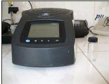
**Figure 3.3:** Spectrophotomètre ODYSSEY.
