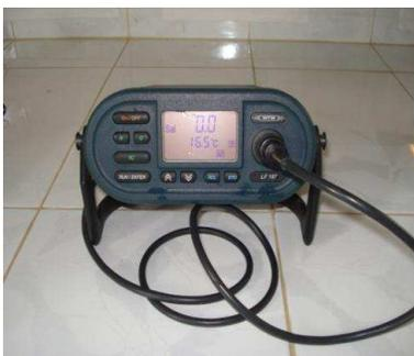
Figure 3.2: Multi-paramètre WTW.
