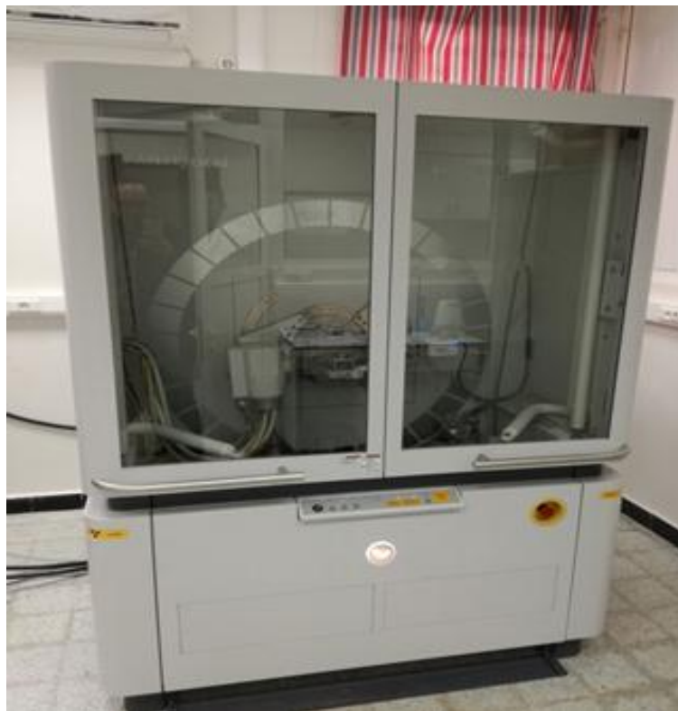
Figure II.6: Diffractomètre à rayons X (PANalytical Empyrean) utilisé.
