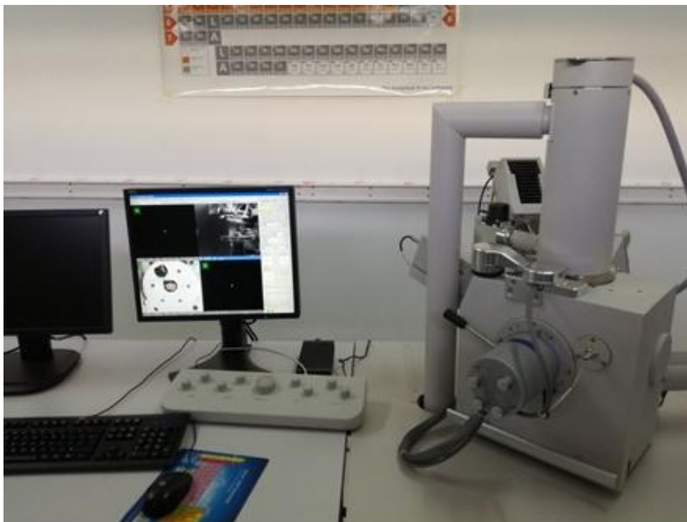
Figure II.5: Microscope électronique à balayage Quanta 250-FEI utilisé.
