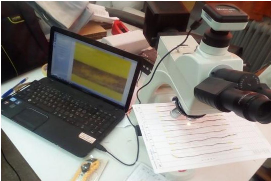
Figure II.3: Microscope optique MOTIC BA310MET-T utilisé.
