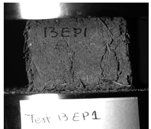
Figure IV.6: Mécanismes d'endommagement des échantillons testés en compression pour : a) Mortier de référence, b) bio-mortier avec la meilleure réponse mécanique et c) bio-mortier avec la plus mauvaise réponse mécanique.
