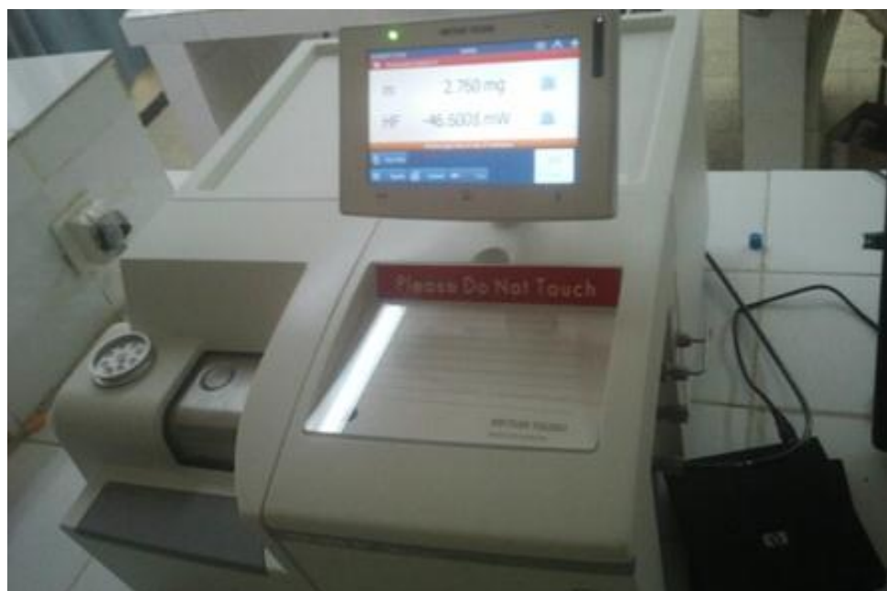
Figure II.8: Analyse thermogravimétrique ATG de type METTLER TOLEDO DSC 3+.
