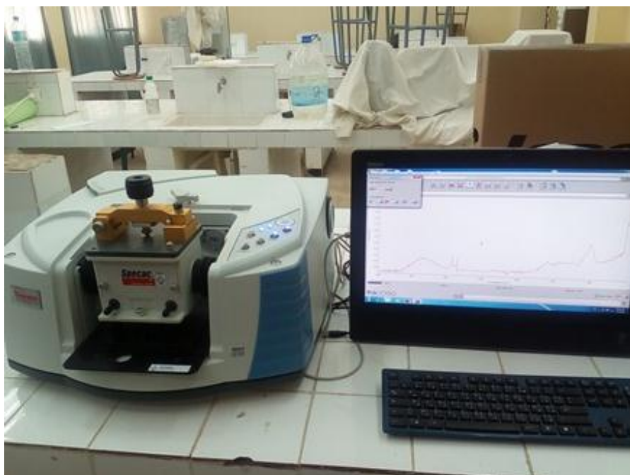
Figure II.7: Spectrométrie Infrarouge à transformée de Fourier de type Thermo Scientific Nicolet iS10.
