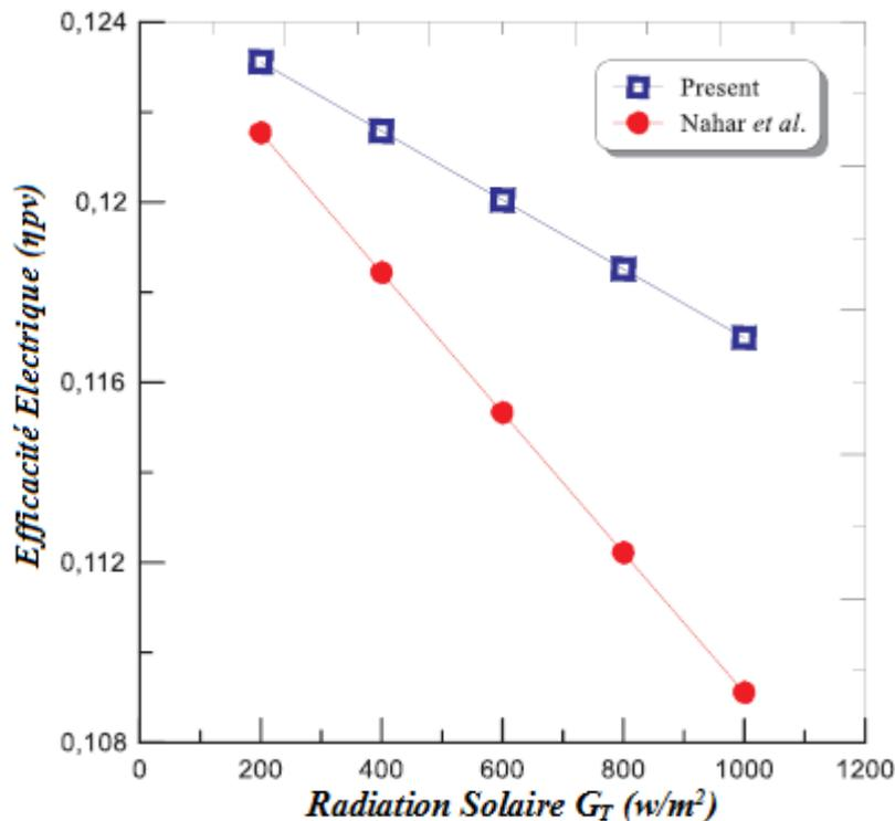
Figure 4- 18 :Variation du rendement électrique  $\eta_{pv}$  avec le rayonnement solaire.
