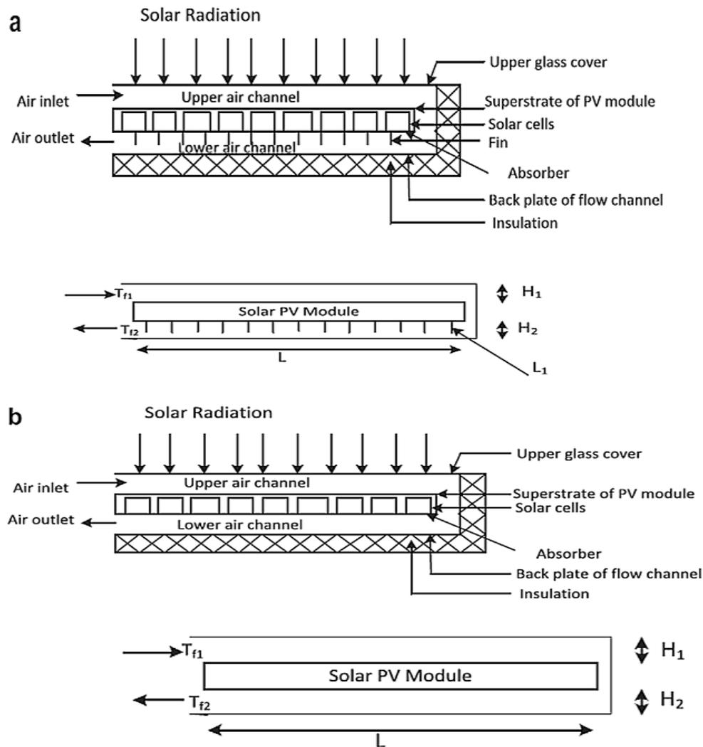
**Figure 1- 9 :** (a) Vue en coupe d'un aérotherme solaire PV / T à double passage avec ailettes. (b) Vue en coupe de l'aérotherme solaire PV / T à double passage sans ailettes (Kumar et Rosen 2011).
