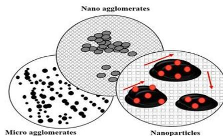
**Figure 5- 20:**La formation de nanoparticules, micro et nanocluster et leur comportement dans différentes conditions et leur phénomène derrière le transport thermique à l'échelle nanométrique.
