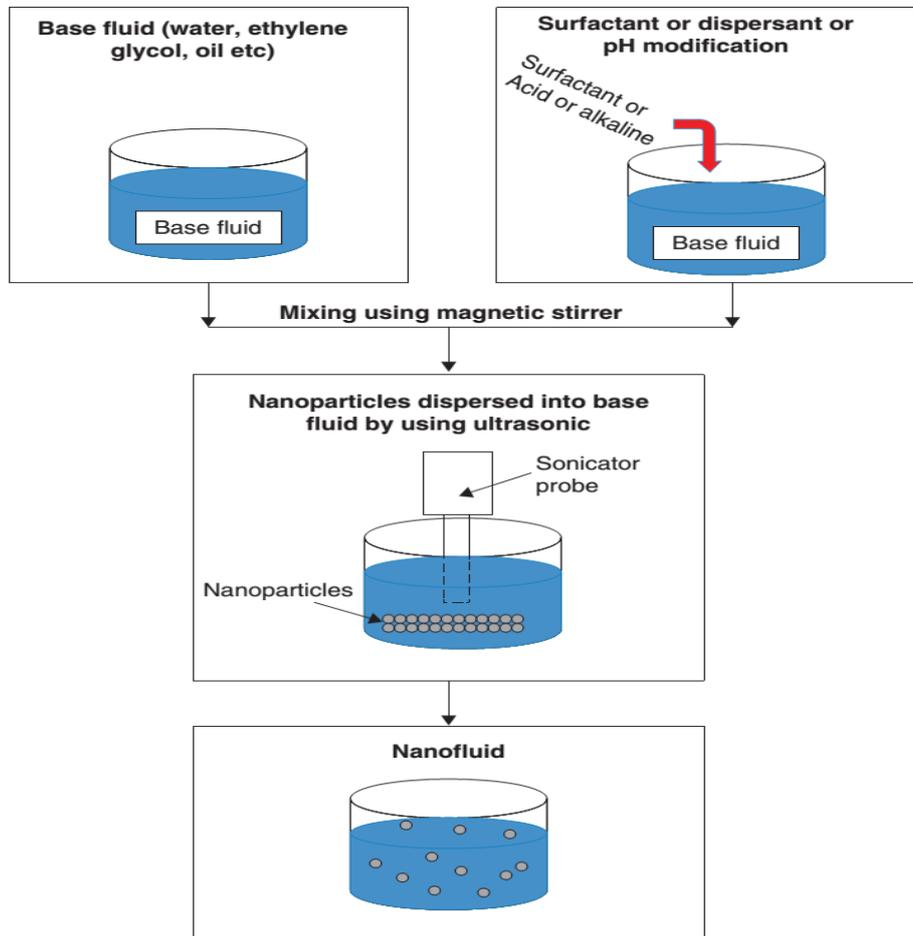
**Figure 5- 12:**Méthode de deux étapes souvent utilisée pour la préparation du nanofluid TiO<sub>2</sub>[76].
