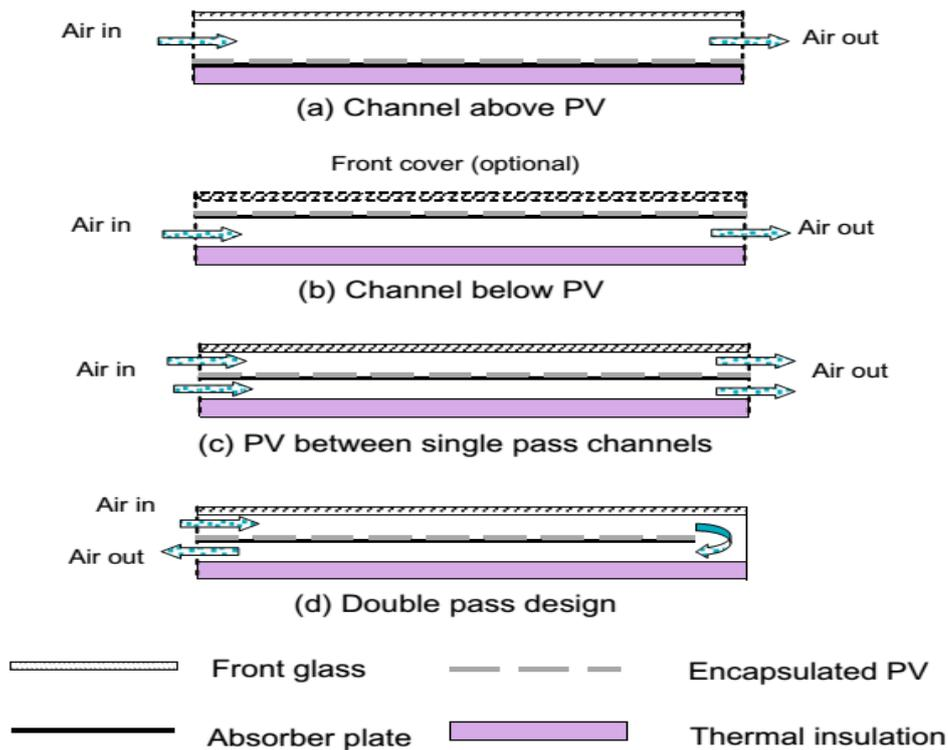
Figure 1- 18: Coupe longitudinale de certains modèles de capteurs PV/T courants.
