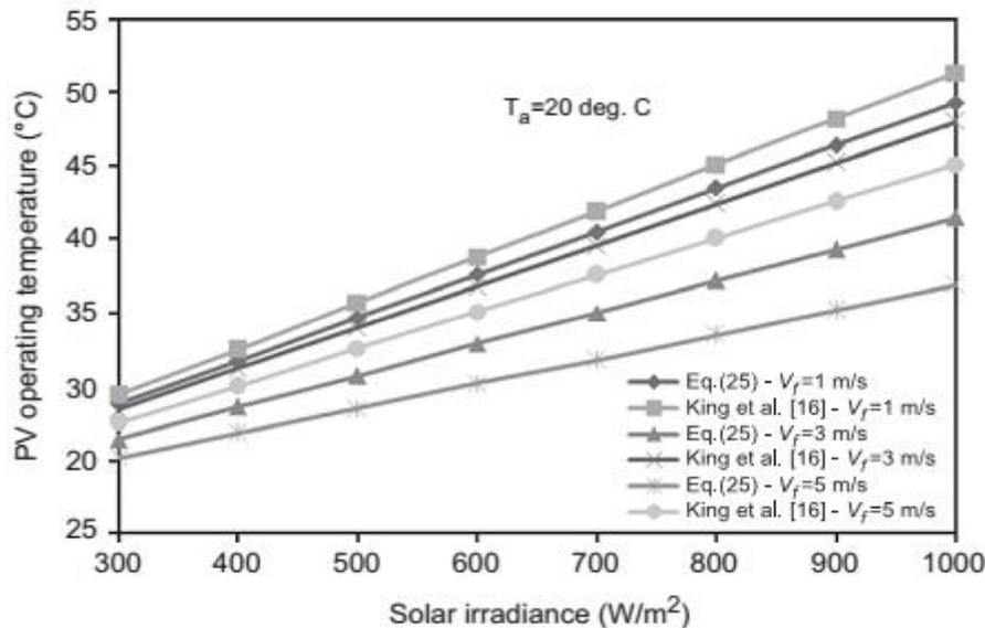
Figure 1- 2:Température de fonctionnement par rapport à la radiation solaire. [4].
