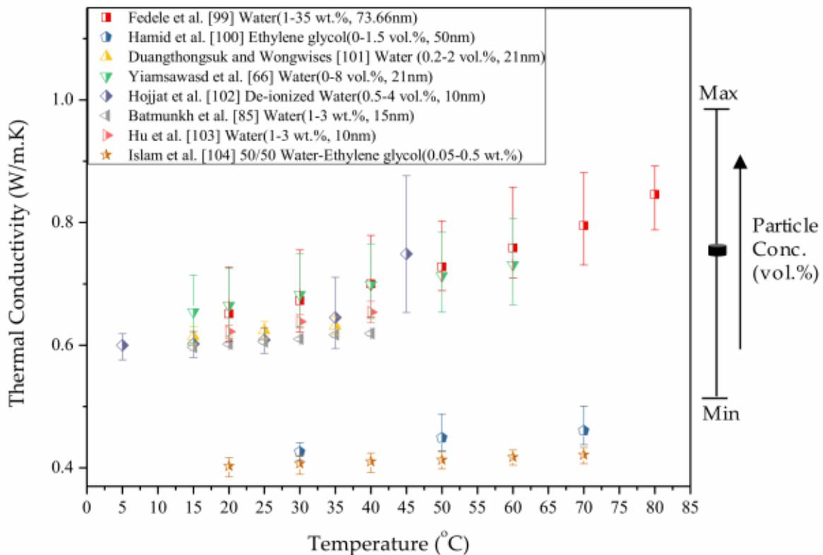
**Figure 5- 15:**La conductivité thermique du nanofluide de TiO<sub>2</sub> en fonction de la température issue de diverses études.
