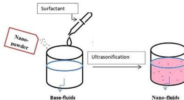
**Figure 5- 3 :** Schéma du processus de préparation de nanofluides en deux étapes.
