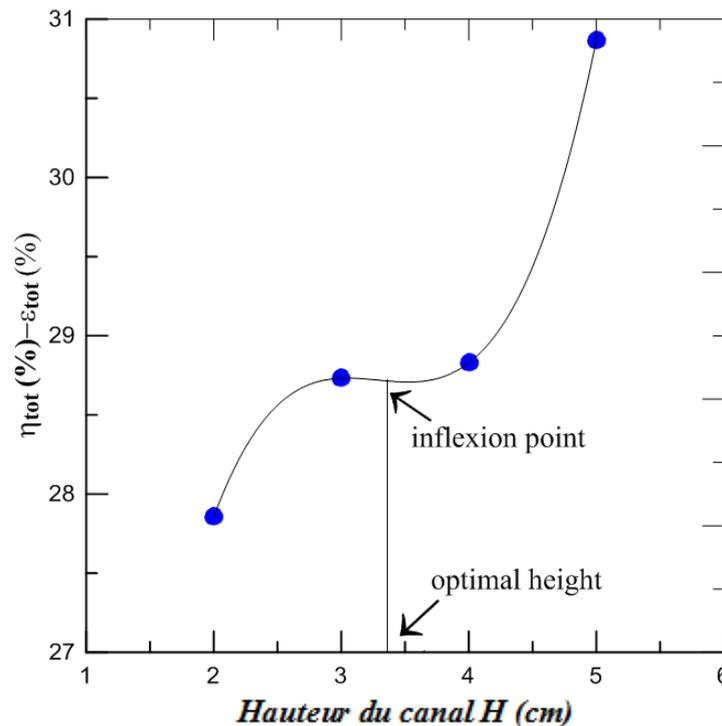
**Figure 8- 2:** Effet de la hauteur du canal  $H$  sur le paramètre  $(\eta(\%) - \varepsilon(\%))$  (calculs avec  $G_T$ ).
