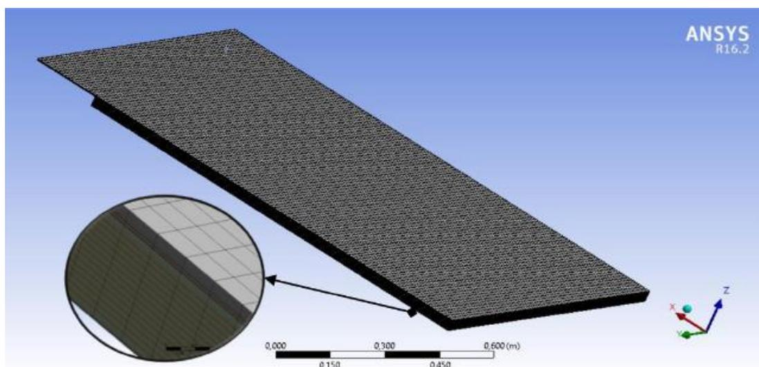
**Figure 4- 2 :**Maillage du capteur solaire hybride (PV/T) à base d'eau proposé par Nahar et al. (2017) sous ANSYS Fluent.
