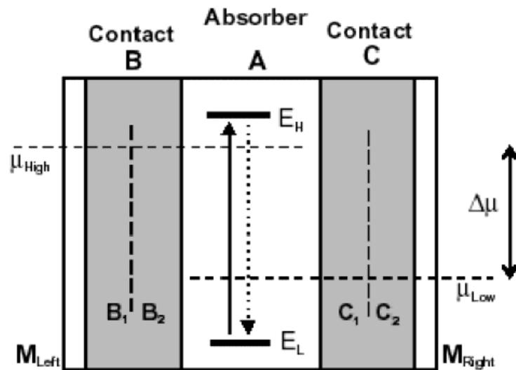
Figure 1- 1 :Schéma d'un convertisseur photovoltaïque idéalisé[2].
