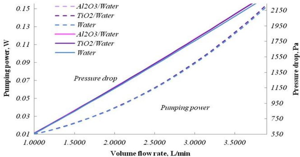
**Figure 5- 19:**Effet du débit volumique sur la puissance de pompage et la perte de charge pour les nanofluides Al<sub>2</sub>O<sub>3</sub>-eau et TiO<sub>2</sub>-eau.
