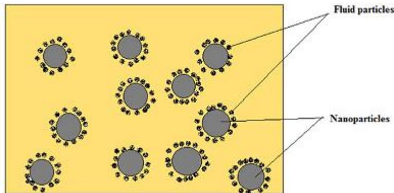
**Figure 5- 14:**Structure nanofluide composée de nanoparticules.
