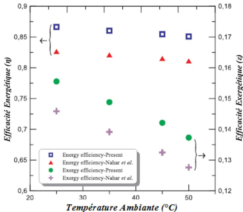
**Figure 4- 6 :** Variation des rendements globaux du (PV/T) avec la température ambiante.
