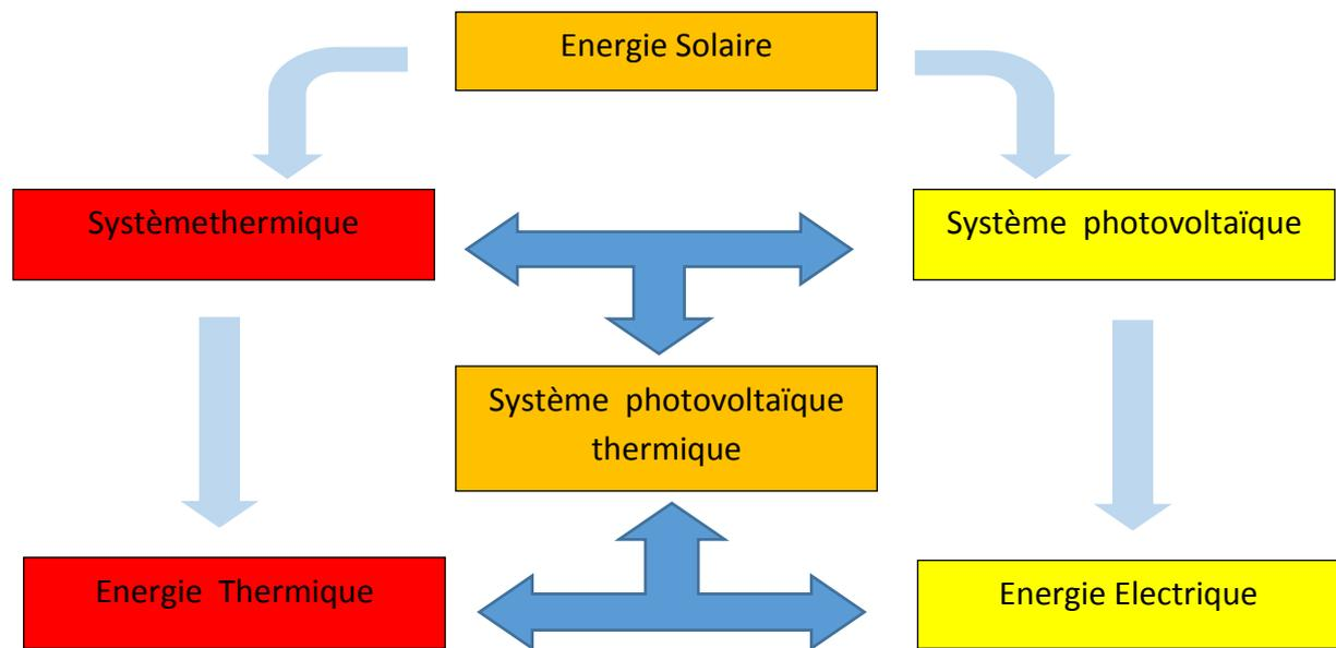
**Figure 1- 8:**Schéma de diverses technologies solaires.
