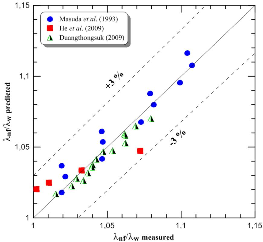
**Figure 6- 1:** Rapport des conductivités thermiques pour le nanofluide eau-TiO<sub>2</sub> ( $\lambda_{nf}/\lambda_{bf}$ ) prédit par l'Eq. 6.1 en fonction du rapport ( $\lambda_{nf}/\lambda_{bf}$ ) mesuré.
