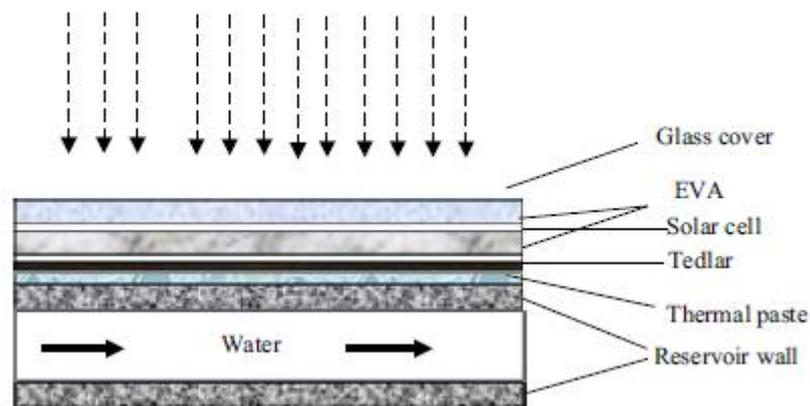
**Figure 4- 1** : Coupe transversale du capteur solaire hybride (PV/T) proposé par Nahar et al. (2017).
