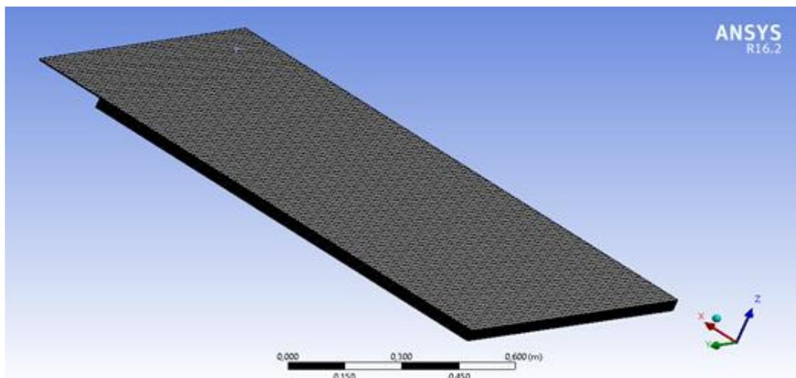
**Figure 6- 4:**Collecteur (PV/T) maillé pas ANSYS FLUENT<sup>®</sup>.
