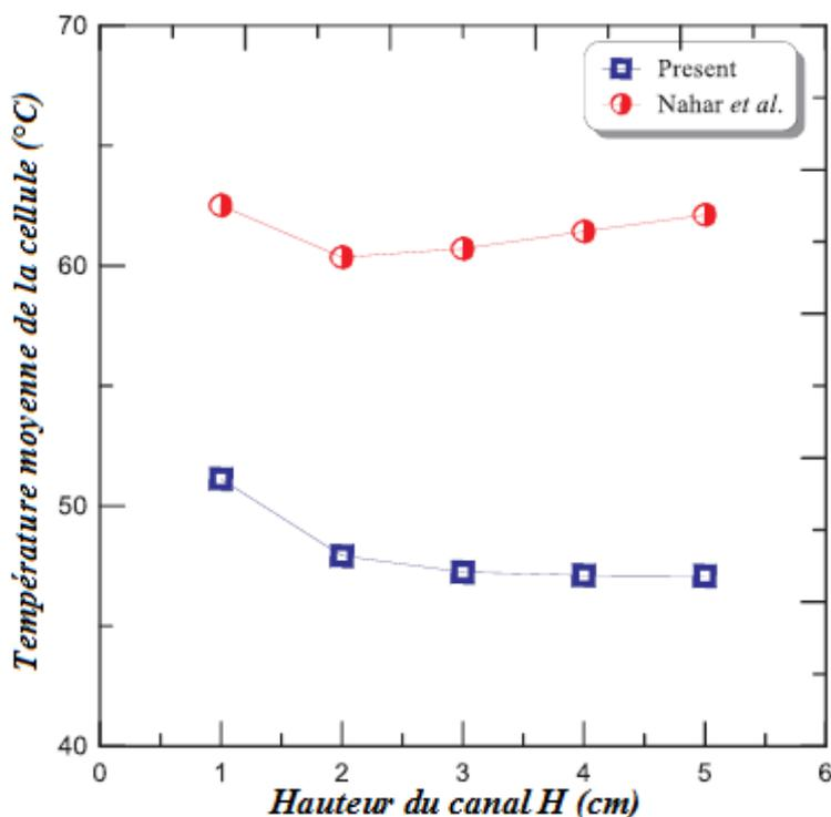
**Figure 4- 13 :** Variation de la température moyenne des cellules PV avec la hauteur du canal H.
