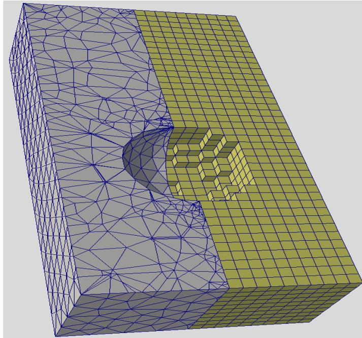
**Figure 3- 1:** Model de maillage structuré et non structuré.
