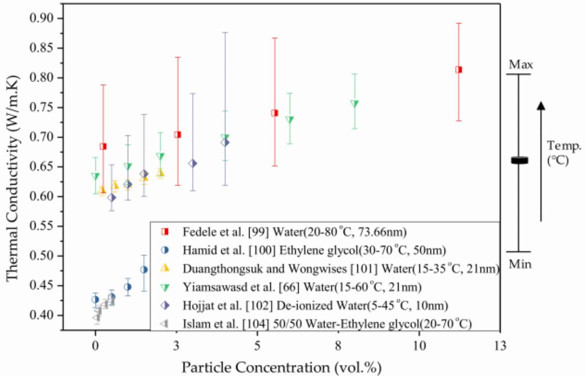
Figure 5- 16:La conductivité thermique de nanofluide TiO<sub>2</sub> en fonction de la concentration de diverses études.
