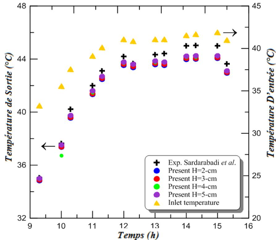
**Figure 7- 4:** Comparaison de la température de sortie du nanofluide eau-TiO<sub>2</sub> mesurée quotidiennement du (PV/T) par [238, 239] avec celle calculée pour le (PVT) à canal pour différentes hauteurs de canal.
