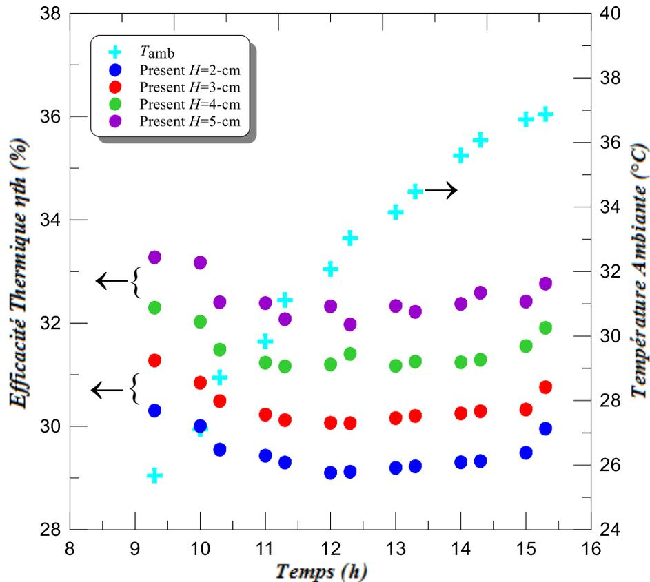
**Figure 7- 8 :** Variation quotidienne du rendement thermique pour le (PV/T) avec canal en utilisant l'irradiation solaire totale  $G_T$  pour différentes hauteurs  $H$  de canal de refroidissement.
