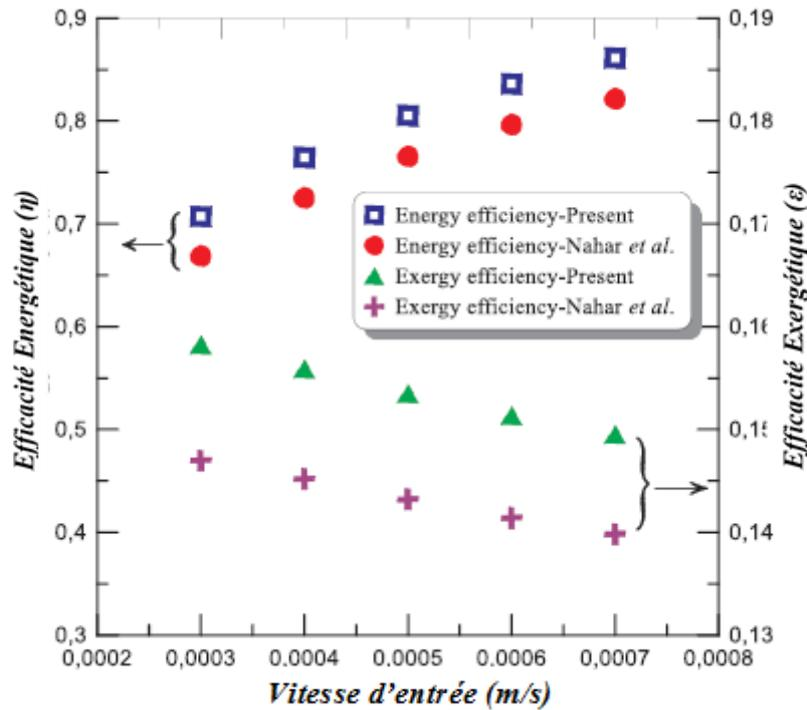
**Figure 4- 15 :** Variation des rendements globaux du (PV/T) avec la vitesse d'entrée de l'eau.
