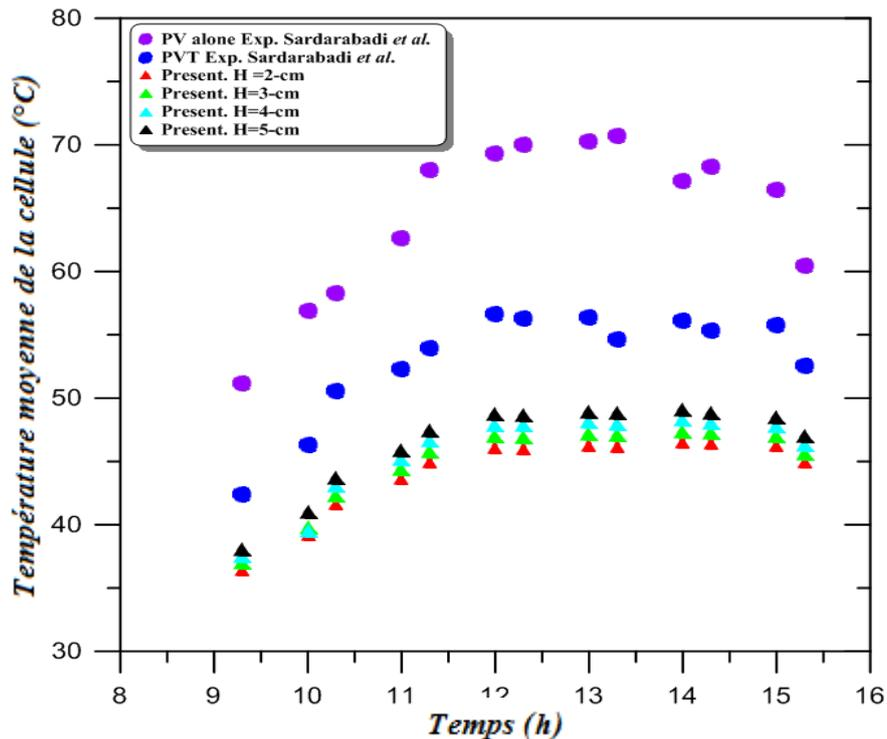
**Figure 7- 3 :** Comparaison de la température de surface mesurée quotidiennement du PV et (PV/T) par [238, 239] avec le présent (PV/T) calculé pour différentes hauteurs de canal.
