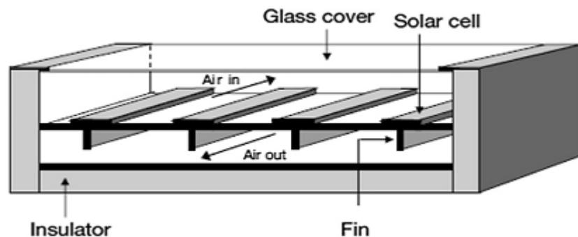
**Figure 1- 12 :**Le Modèle schématique d'un collecteur d'air photovoltaïque / thermique à ailettes double passe (Othman et al. 2007).
