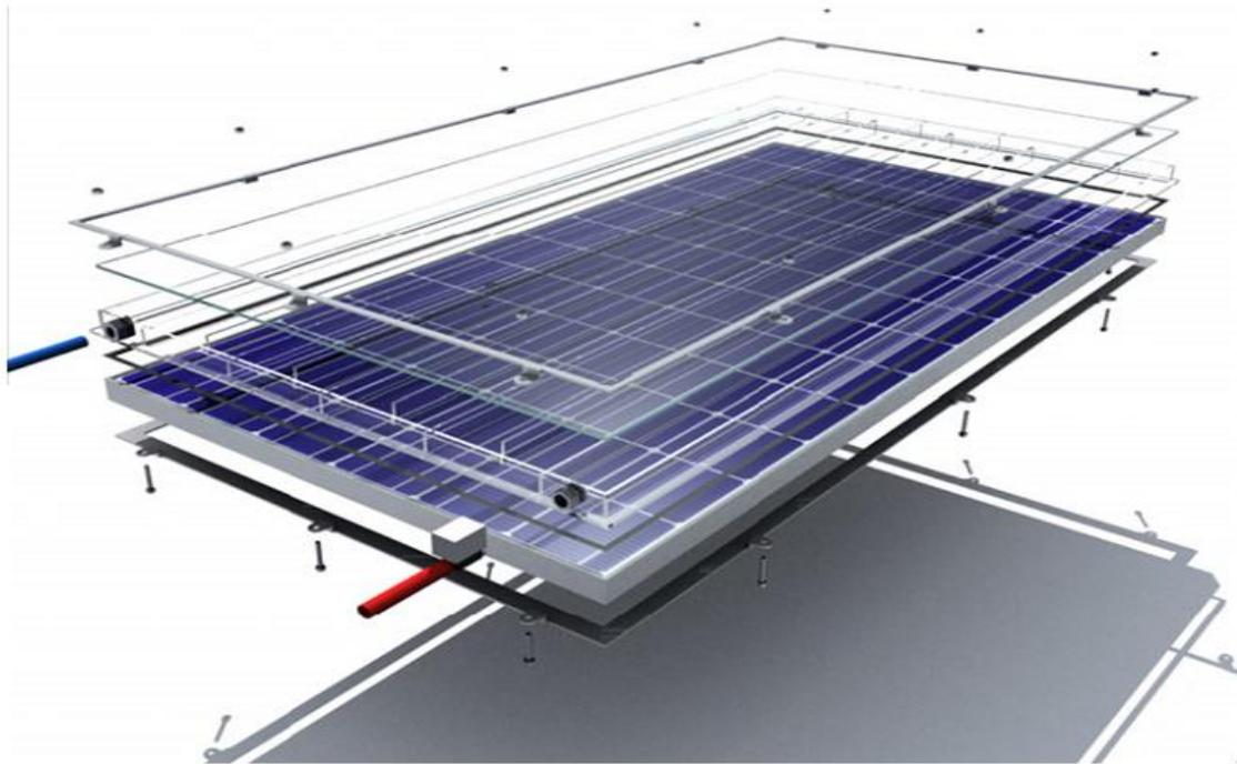
Figure 1- 16 : Vue éclatée du panneau TESPI (Rosa-Clot et al.2011)
