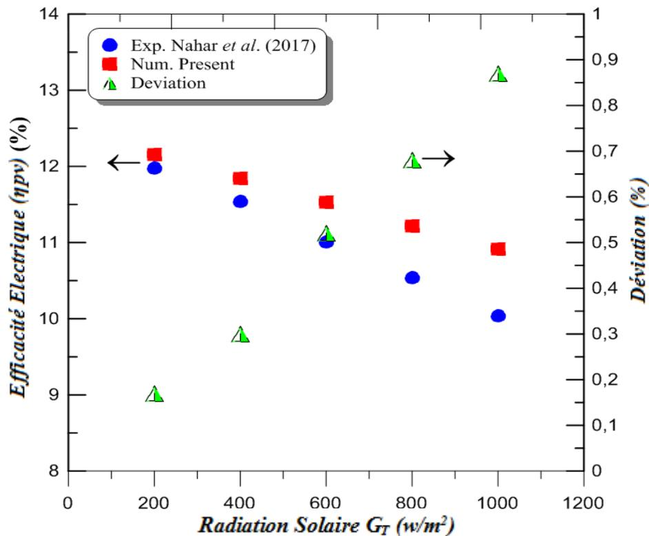
Figure 7- 2:Effet de l'irradiation solaire sur le rendement électrique du PV.
