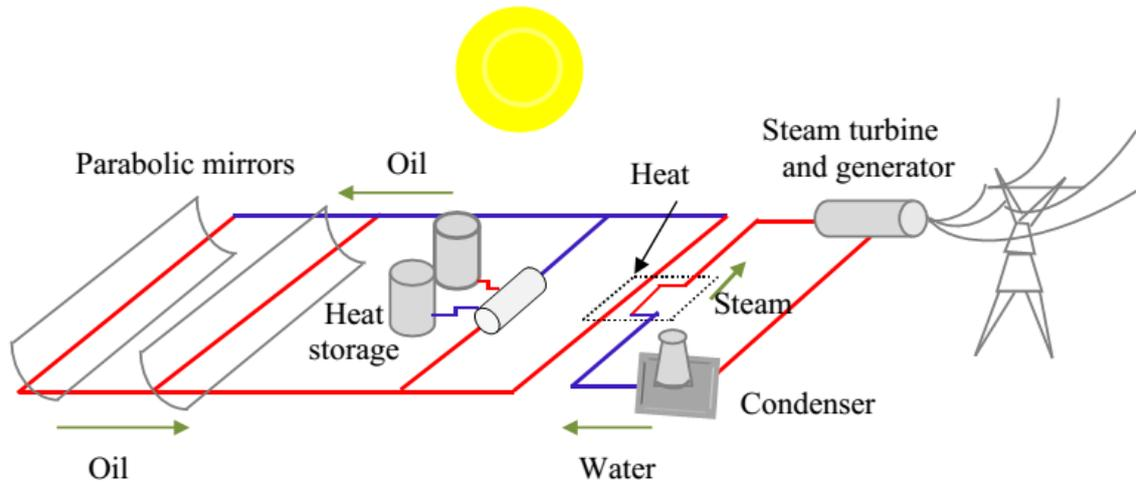
*Figure 1- 7:*Centrale solaire thermique.
