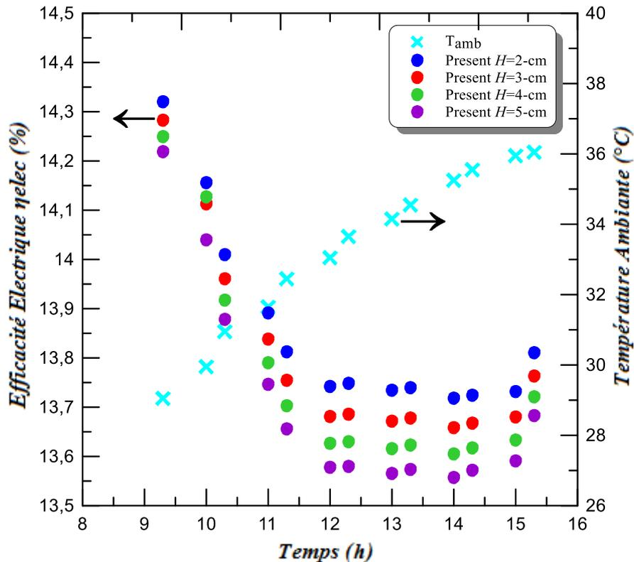
Figure 7- 7: Variation quotidienne du rendement électrique calculé du (PV/T) à canal pour différentes hauteurs du canal de refroidissement  $H$ .
