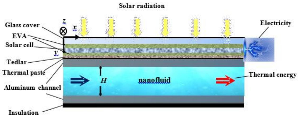
**Figure 6- 3 :** Vue en coupe de PV/T hybride proposé par [44].
