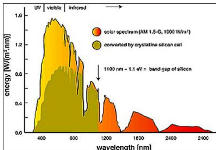
Figure 1- 23: Absorption de la lumière par les cellules de Silicium.
