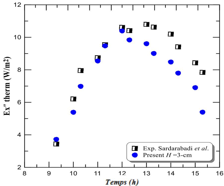
**Figure 7- 6 :** Comparaison de l'exergie thermique quotidienne par unité de surface du (PV/T) par [238, 239] avec celle calculée pour le (PV/T) à canal ( $H = 3$  cm).
