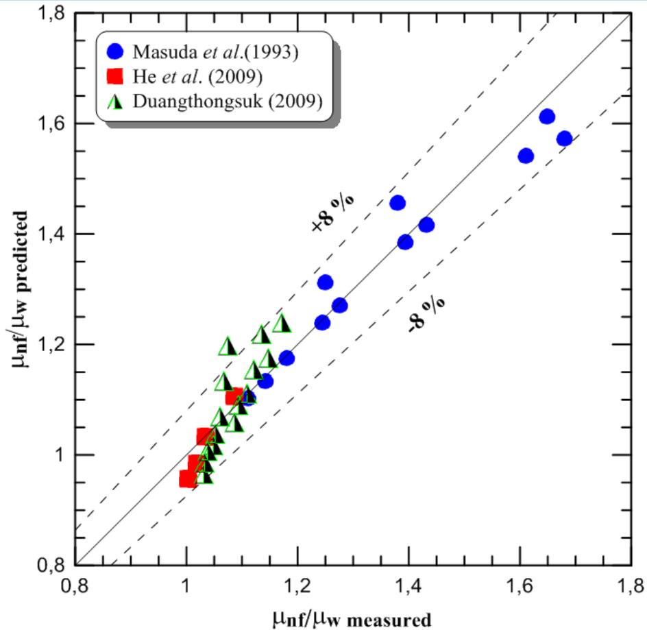
**Figure 6- 2 :** Rapport des viscosités dynamiques pour le nanofluide eau-TiO<sub>2</sub> ( $\mu_{nf}/\mu_{bf}$ ) prédit par l'Eq. 6.2 en fonction du rapport ( $\mu_{nf}/\mu_{bf}$ ) mesuré.
