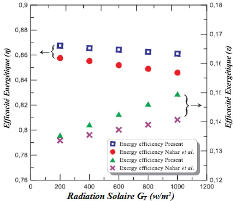
Figure 4- 17 :Variation des rendements globaux avec le rayonnement solaire.
