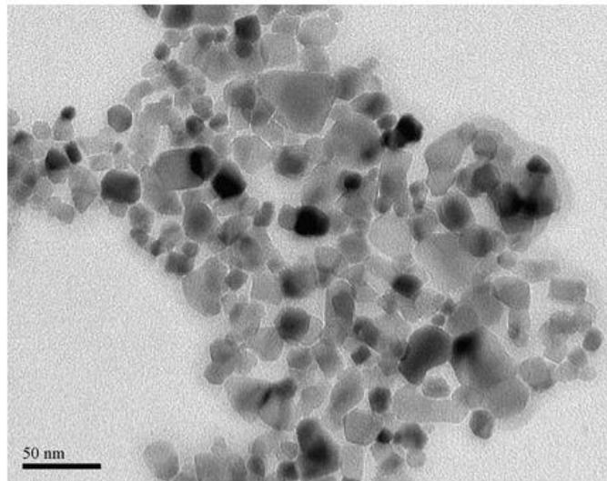
*Figure 5- 9:*Image TEM de nanoparticules de TiO<sub>2</sub> dispersées dans l'eau. [57].
