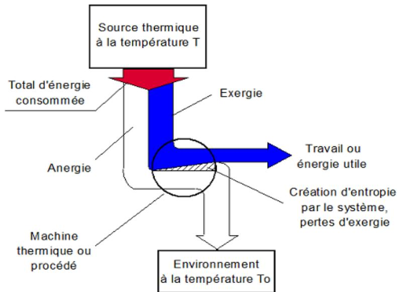
**Figure 2- 1 :** les notions d'exergie et d'anergie-schéma simplifié.
