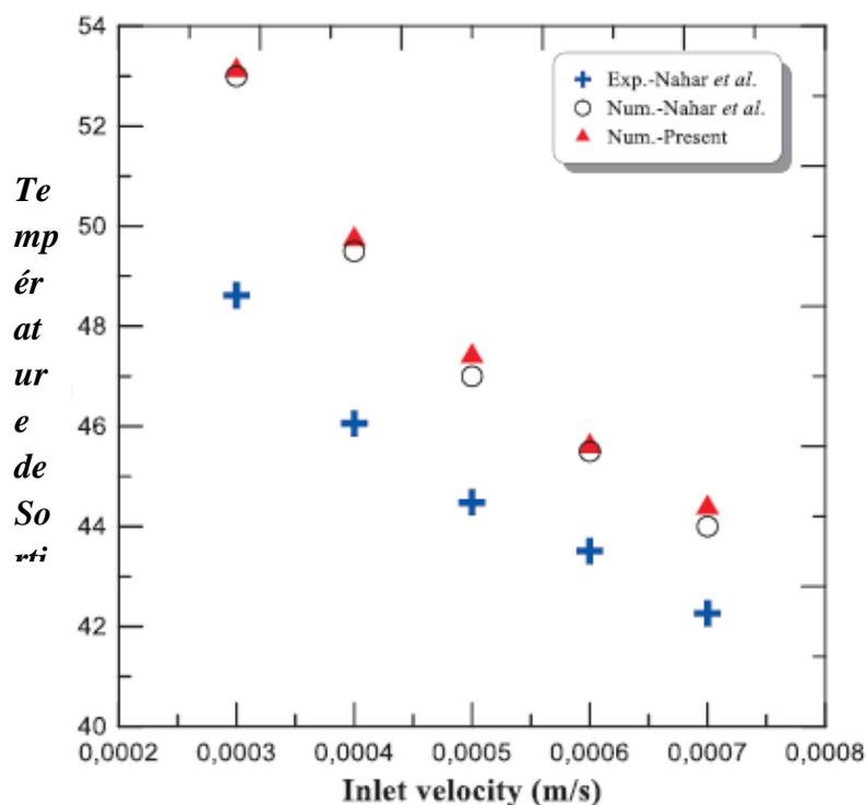
**Figure 4- 4:** Effet de la vitesse d'entrée de l'eau sur sa température de sortie.
