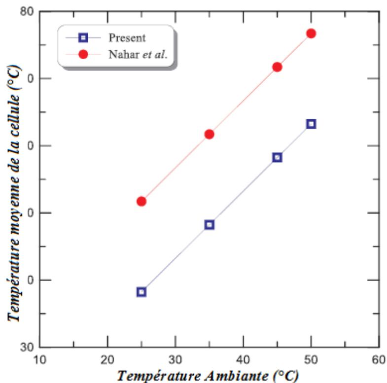
Figure 4- 7 : Variation de la température moyenne des cellules avec la température ambiante.
