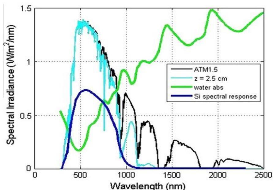
**Figure 1- 22:** L'absorption du spectre solaire par l'eau en fonction de la longueur d'onde.
