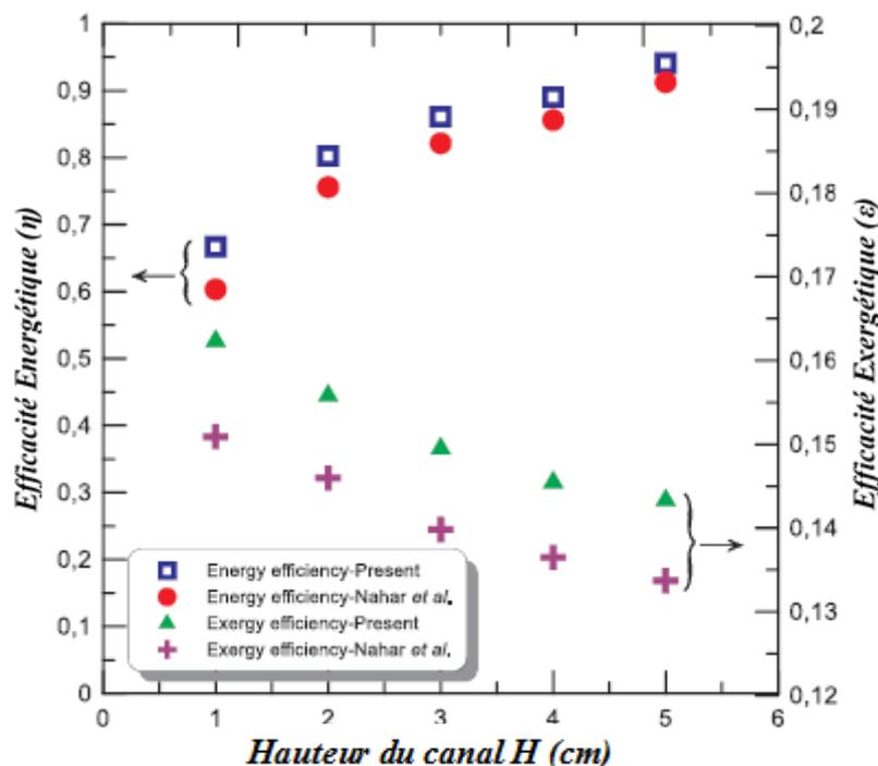
Figure 4- 9 :Variation des rendements globaux du (PV/T) avec la hauteur de canal  $H$ .
