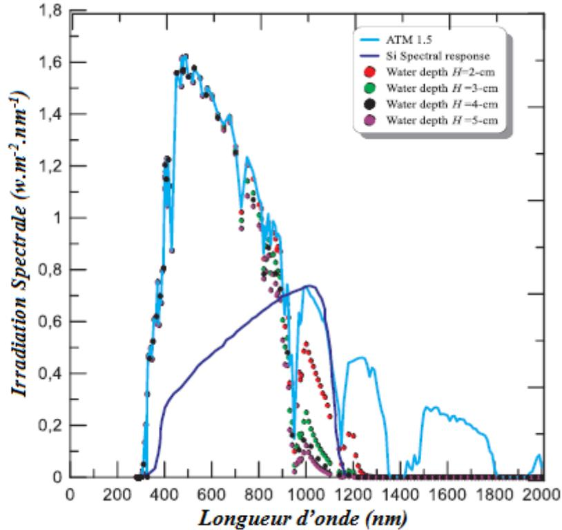
**Figure 4- 14 :** Variation des radiations solaires à différentes profondeurs d'eau et réponses spectrales d'une seule cellule solaire Si avec la longueur d'onde.
