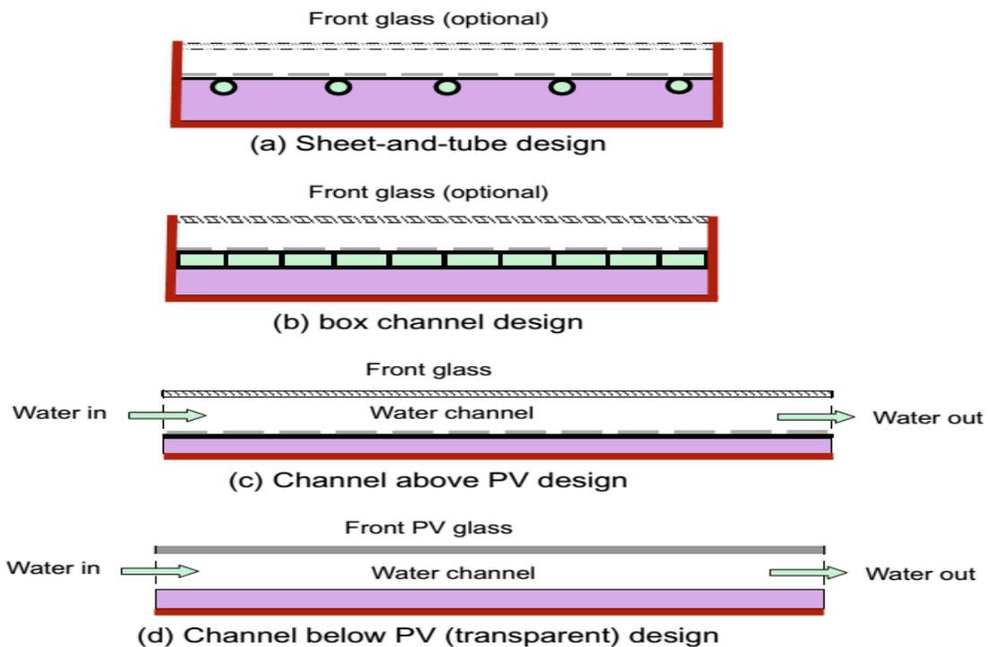
Figure 1- 19: Coupe transversale de certains modèles de capteurs PV/T courants.
