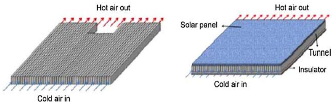
**Figure 1- 11 :** PV/T à un seul passage avec conception de tunnel rectangulaire (Jin et al. 2010).
