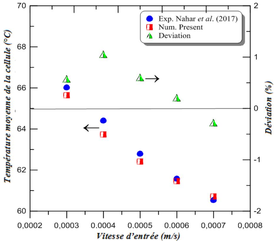
Figure 7- 1 :Effet de la vitesse d'entrée de l'eau sur la température moyenne de la cellule PV.
