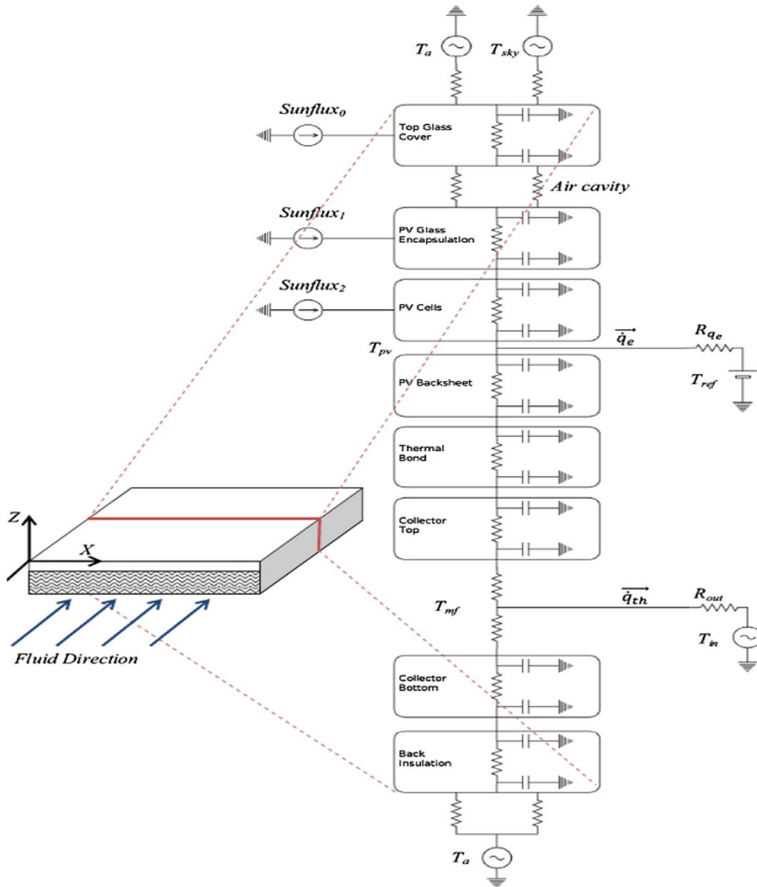
Figure 1- 14 : Schéma du modèle RC pour PVT vitré (Bilbao et Sproul, 2015).
