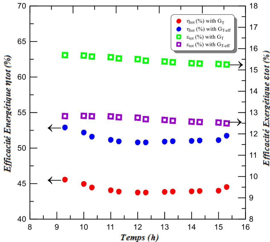
**Figure 7- 9:** Variation quotidienne des rendements énergétiques et exergetiques globaux pour le capteur hybride(PV/T) avec canal de refroidissement.
