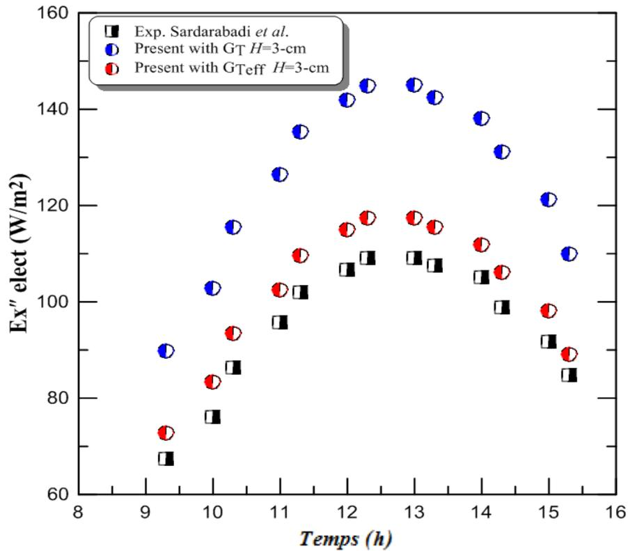
**Figure 7- 5 :** Comparaison de l'exergie électrique quotidienne par unité de surface du (PV/T) par [238, 239] avec celle calculée pour le présent (PV/T) pour l'irradiation solaire totale  $G_T$  et sa valeur effective  $G_{Teff}$ . ( $H = 3$ -cm).
