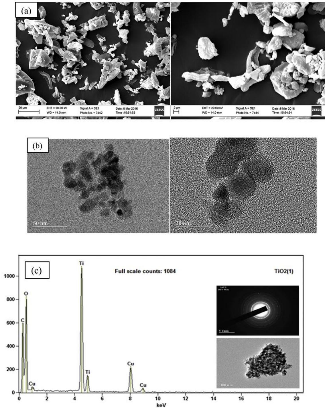
**Figure 5- 5:**(a) Images MEB de poudre de nanoparticules de TiO<sub>2</sub> d'une taille moyenne de 11 nm, (b) images TEM de nanoparticules de TiO<sub>2</sub>-PVA dispersées dans l'eau et (c) image spectrale EDX de nanoparticules de TiO<sub>2</sub>-PVA.[52]
