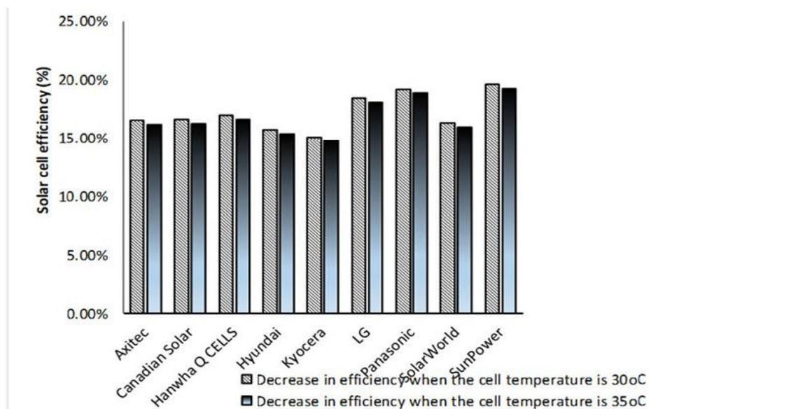
Figure 1- 3 :Effet de La température sur le rendement des panneaux photovoltaïques.[5].
