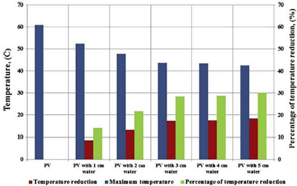
**Figure 4- 11 :** Résultats des mesures expérimentales de la température maximale de la cellule, de la réduction de la température et du pourcentage de réduction de la température après 60 min pour le PV avec différentes épaisseurs d'eau par W.A.M. Al Shohani et al. (Reproduit avec la permission d'Elsevier).
