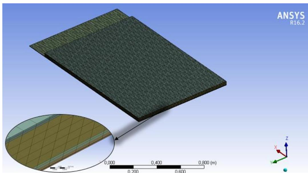
**Figure 4- 3 :**Maillage 3D pour la nouvelle configuration du (PV/T) à base d'eau sous ANSYS FLUENT.
