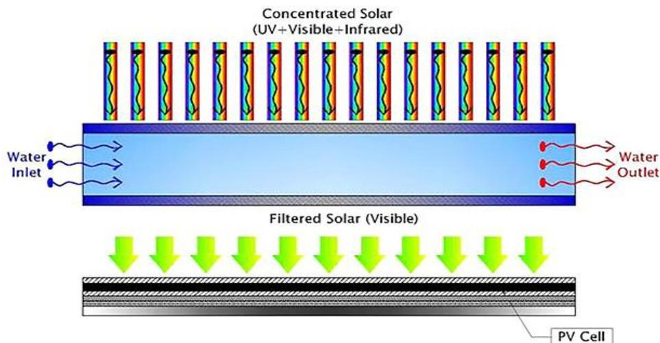
**Figure 3- 3 :** Le processus d'absorption du rayonnement solaire dans le nouveau capteur hybride (PV/T) à base d'eau.
