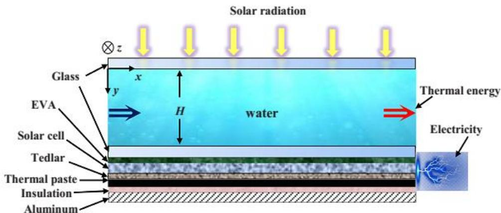
**Figure 3- 2:** La vue en coupe du nouveau capteur solaire hybride (PV/T) à base d'eau.
