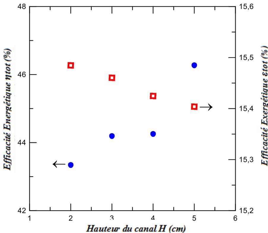
**Figure 8- 1:** Effet de la hauteur du canal  $H$  sur le rendement énergétique global ( $\eta$ ) et exergétique global ( $\varepsilon$ ) du (PV/T) Hybride avec canal de refroidissement rectangulaire (calculs avec  $G_T$ ).
