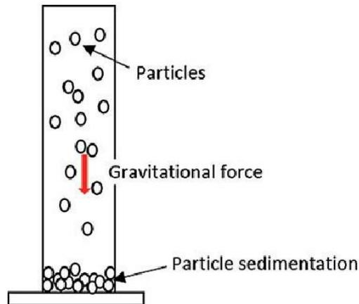
**Figure 5- 11:**Précipitation des nanoparticules dans le fluide de base[76].
