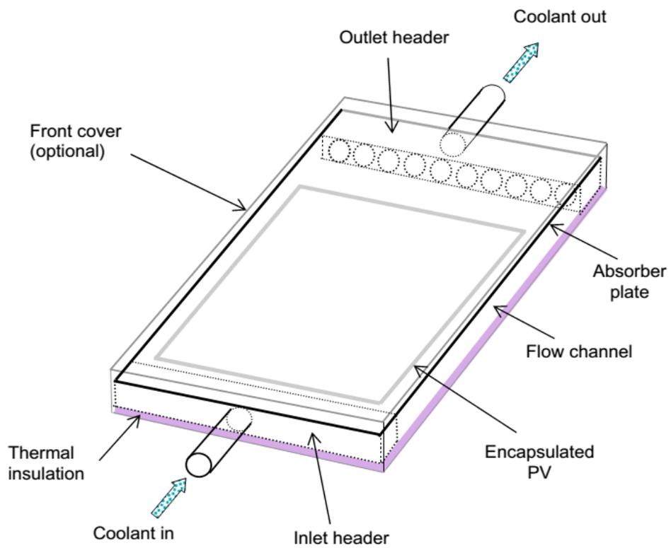
Figure 1- 17 : Principales caractéristiques du capteur plat PV/T.
