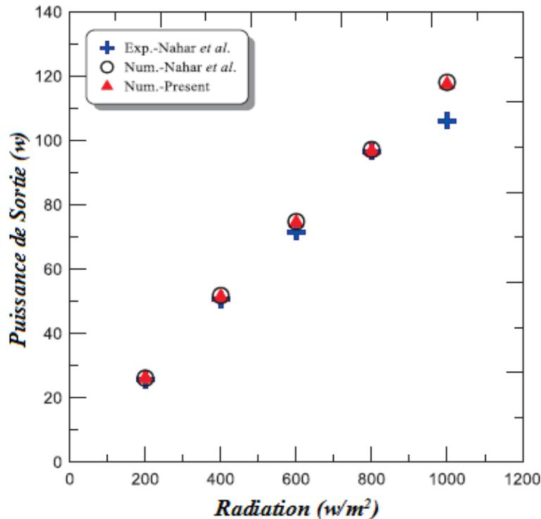
**Figure 4- 5 :** Effet de l'irradiation solaire sur la puissance électrique de sortie du PV
