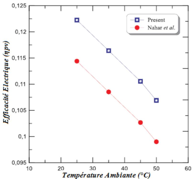
Figure 4- 8 : Variation du rendement électrique  $\eta_{pv}$  avec la température ambiante.
