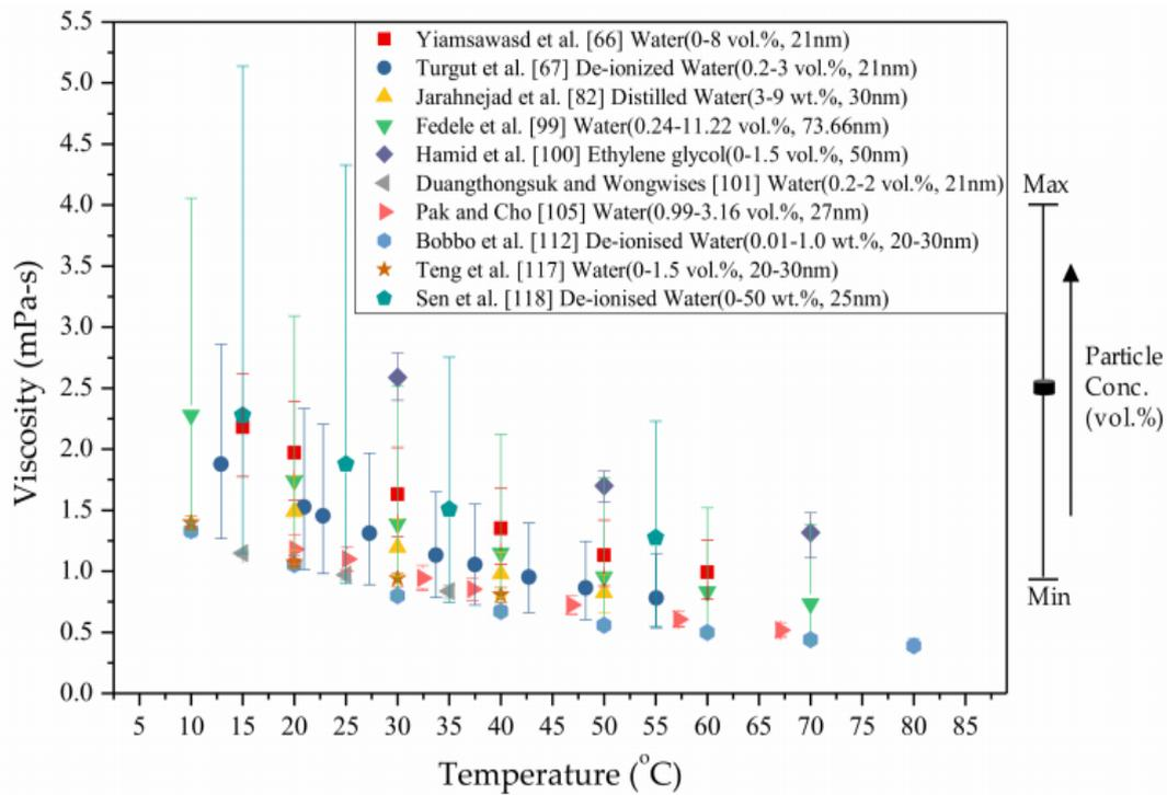
**Figure 5- 17:**Viscosité du nanofluide TiO<sub>2</sub> en fonction de la température pour diverses études.
