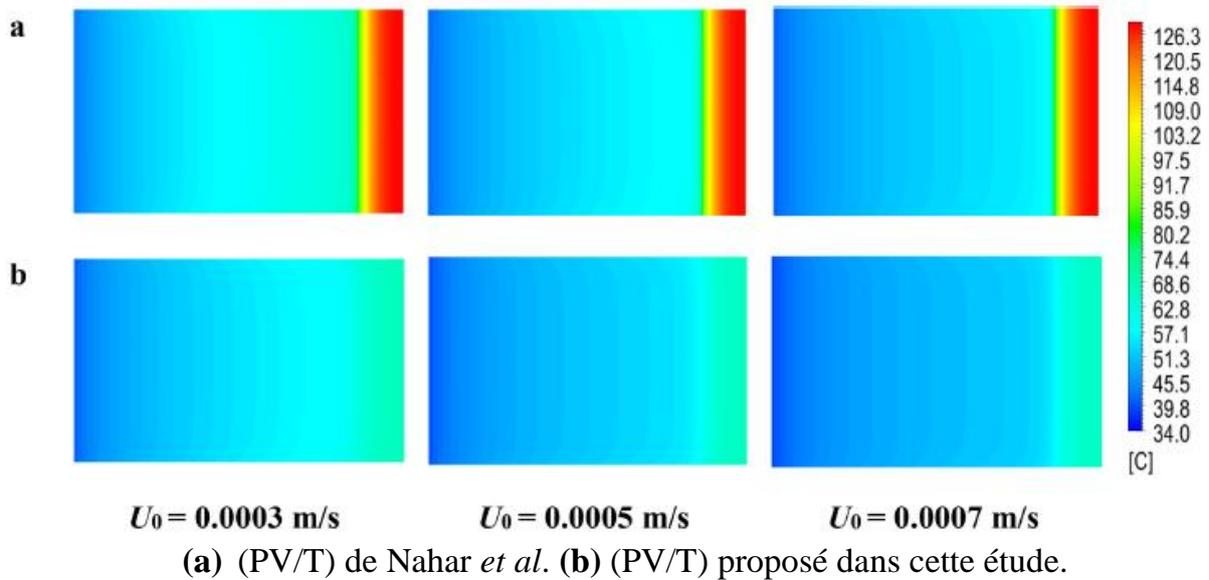
**Figure 4- 16 :** Distribution de la température dans la cellule PV pour différentes vitesses d'entrées de l'eau.
