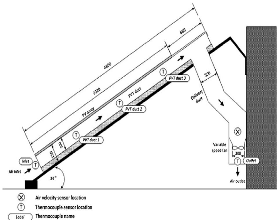
**Figure 1- 10 :** Schéma d'un Système PV/T (Bambrook et sproul 2012).
