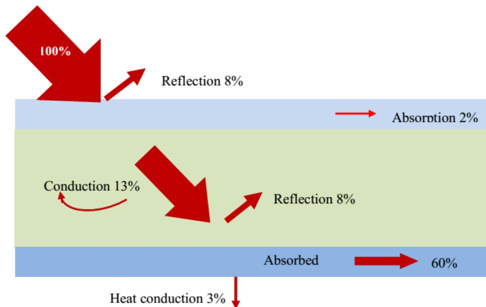
**Figure 1- 4:** Pertes optiques et thermiques d'un collecteur plat (IEA, 2011).
