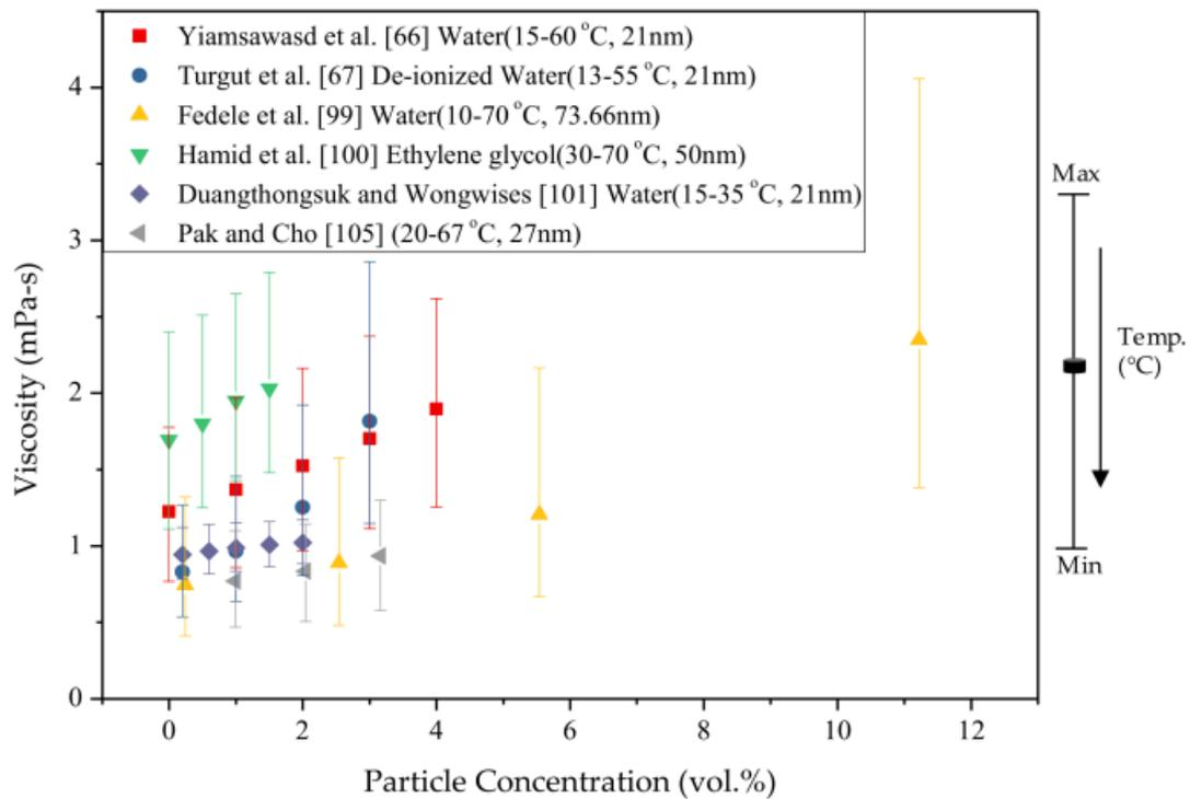
**Figure 5- 18:**Viscosité du nanofluid TiO<sub>2</sub> en fonction de la concentration (vol%) des nanoparticules pour diverses études.
