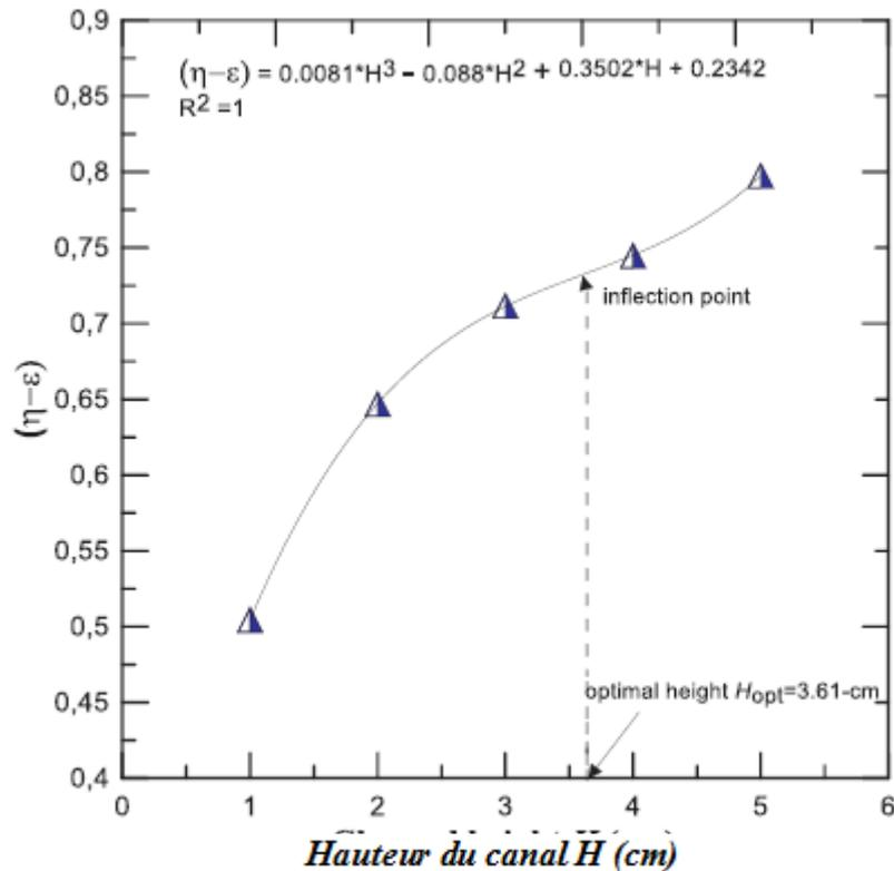
**Figure 4- 10 :** Variation du paramètre ( $\eta - \varepsilon$ ) avec la hauteur du canal H.
