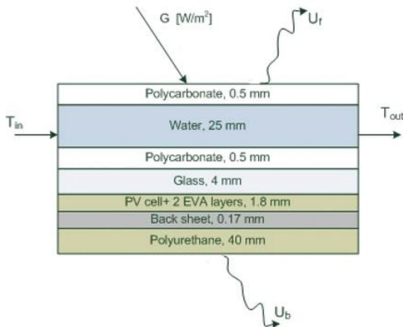
**Figure 1- 15 :**Schéma des couches de TESPI et principaux flux d'énergie. La chaleur est perdue à travers la surface en polycarbonate et la couche inférieure de polyuréthane.
