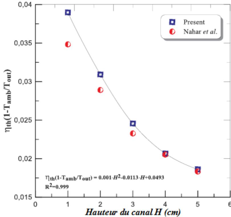
**Figure 4- 12 :** Variation du paramètre  $\eta_{th} \cdot (1 - T_{amb}/T_{out})$  avec la hauteur du canal  $H$ .
