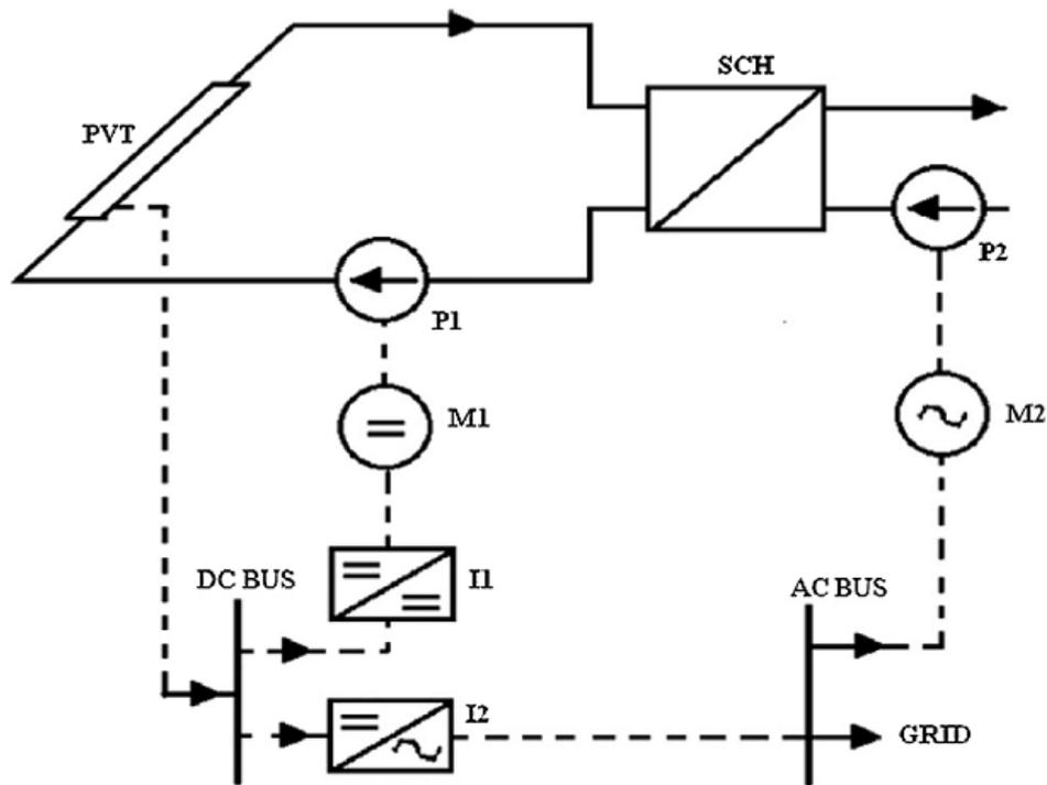
**Figure 1- 13 :** Schéma du système PVT - Système Thermique Photovoltaïque; SCH - Echangeur de Chaleur; P1, P2 - Pompes; Moteur M1-DC M1 - Moteur AC; I1 - Contrôleur CC, I2 - onduleur CC/CA; Boîte de Connexion DC - DC; Boîte de Connexion AC - AC (Hazi et al., 2014).
