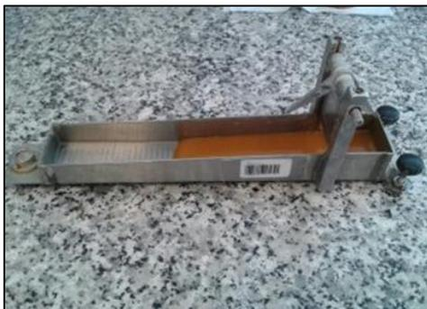
**Figure 13:** Viscosimètre.
