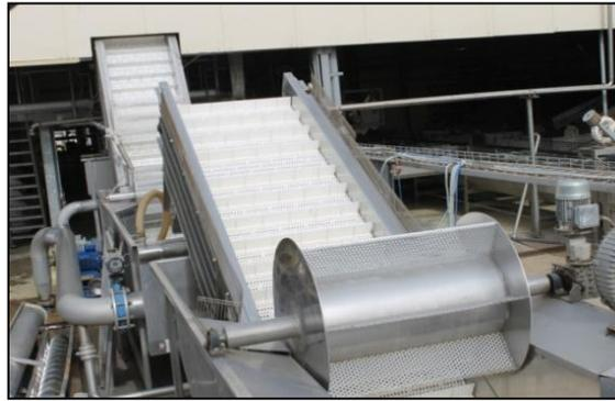
**Figure 06:** Chaîne de lavage et rinçage de l'abricot.
