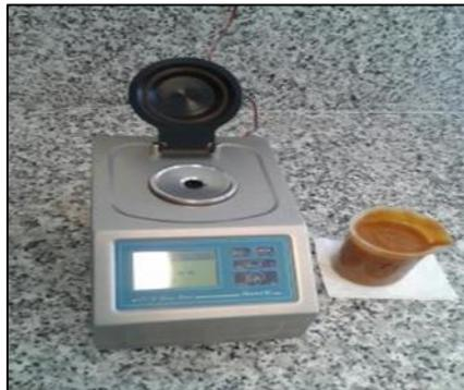
**Figure 15:** Réfractomètre
