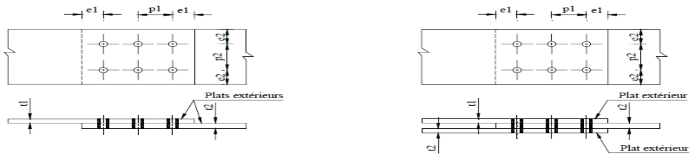
Figure (III.6) Dispositions constructives réglementaire
