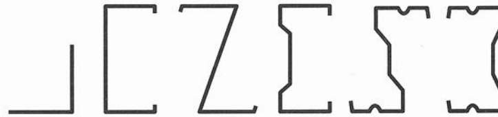
Figure (I.7) Produits longs formés à froid (exemples de sections transversales)
