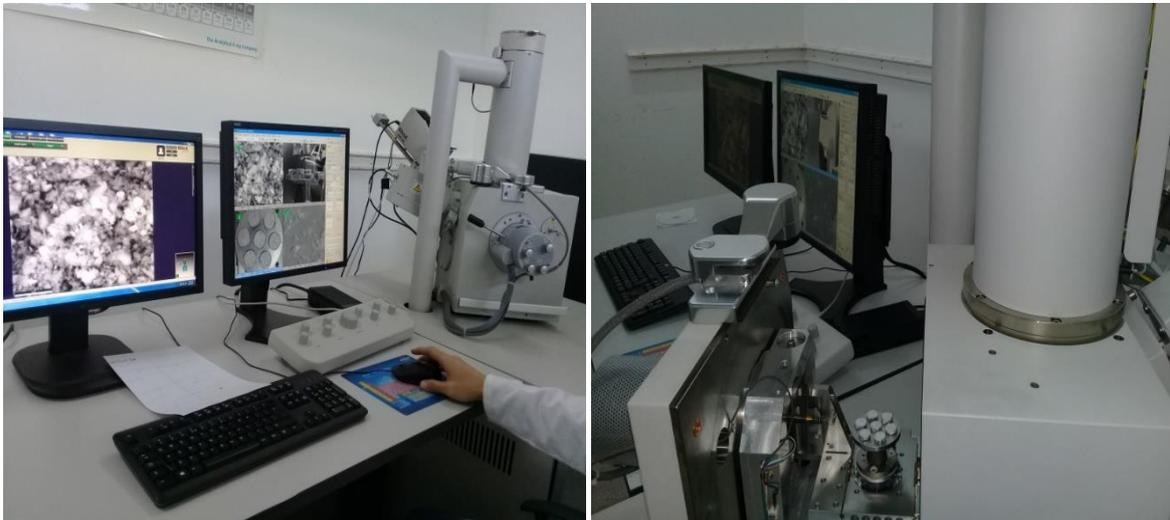
Figure 31 . Appareil Microscope Electronique à Balayage (MEB)
