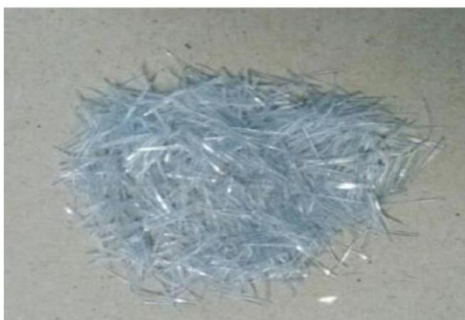
*Figure 22. Fibres de polyéthylène utilisées pour le renforcement du sol*
