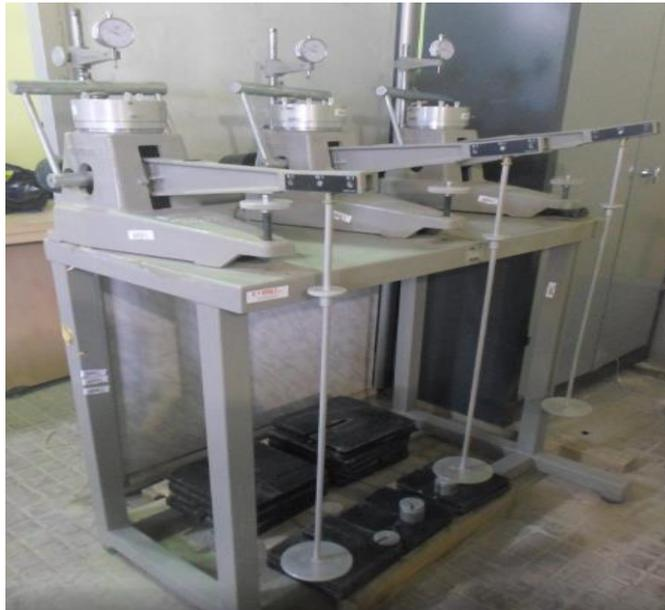
Figure 26. Appareil de l'œdomètre
