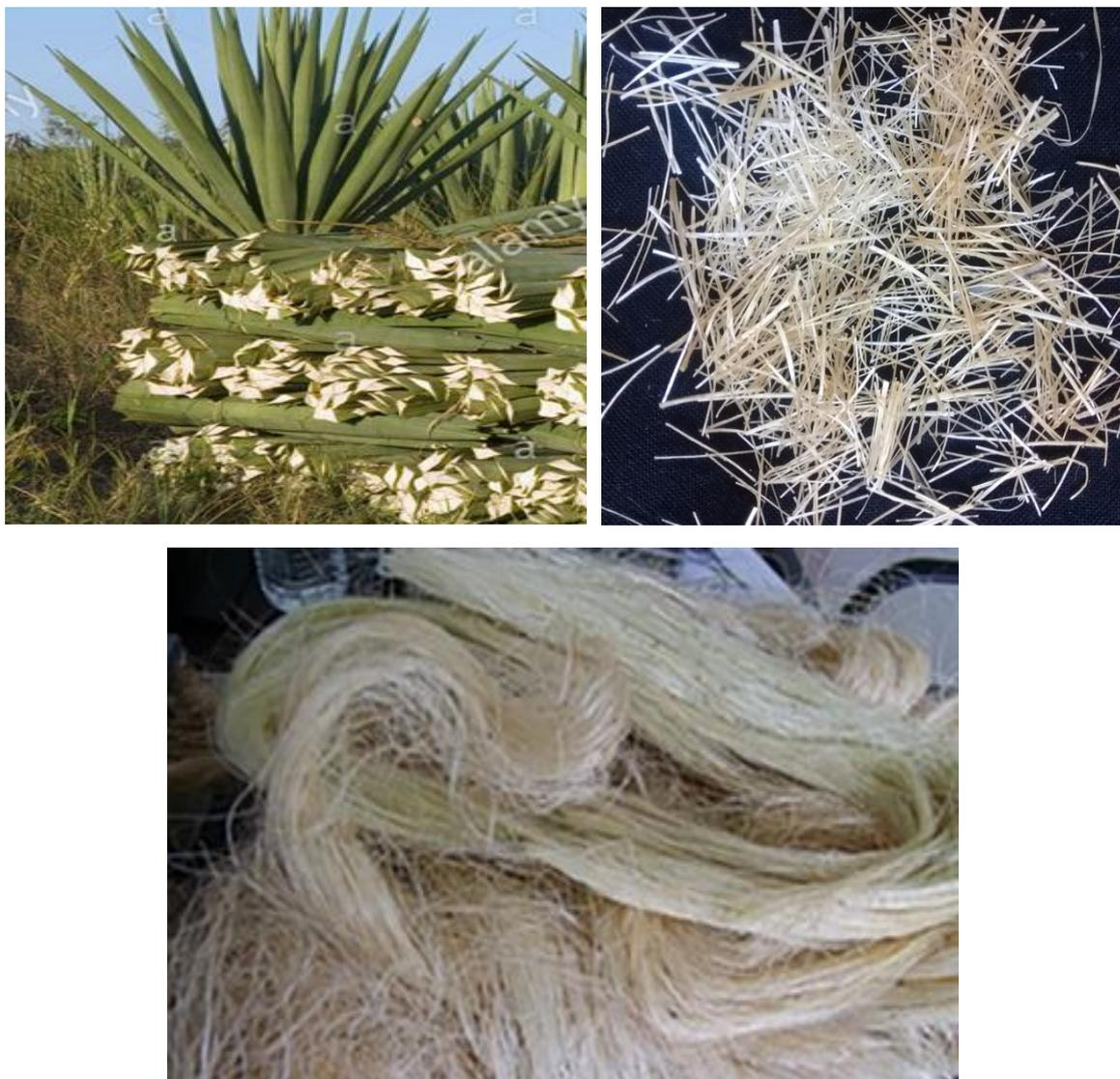
Figure 23. Fibres de sisal utilisées pour le renforcement du sol
