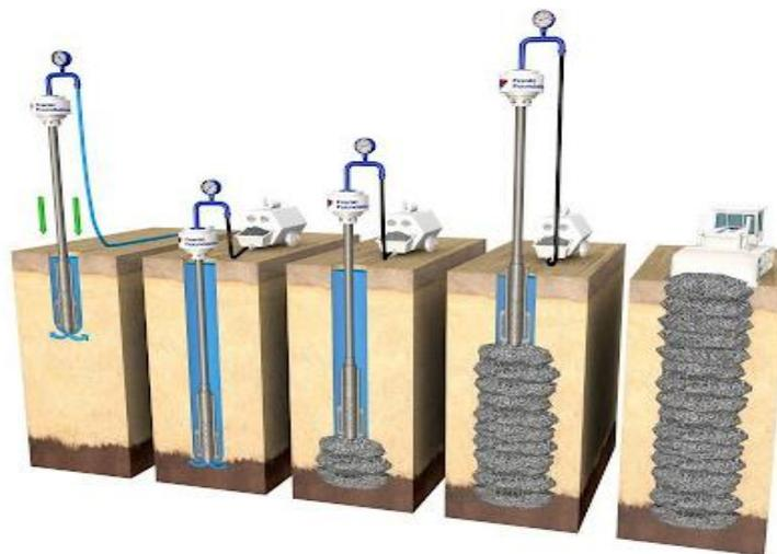
*Figure 12. Traitement du sol par colonne ballastée*
