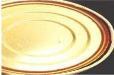
**Figure 27:** Profil du fond fissuré (Cameron, 1997)
