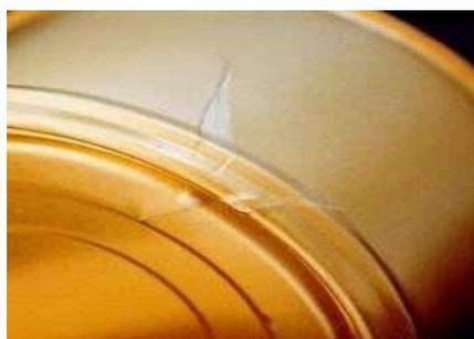
**Figure 32:** Éraflures d'emboutissage (Cameron, 1997)
