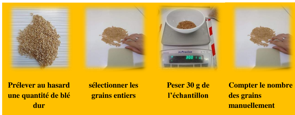
Figure D: Mode opératoire pour déterminer le poids de mille grains.
