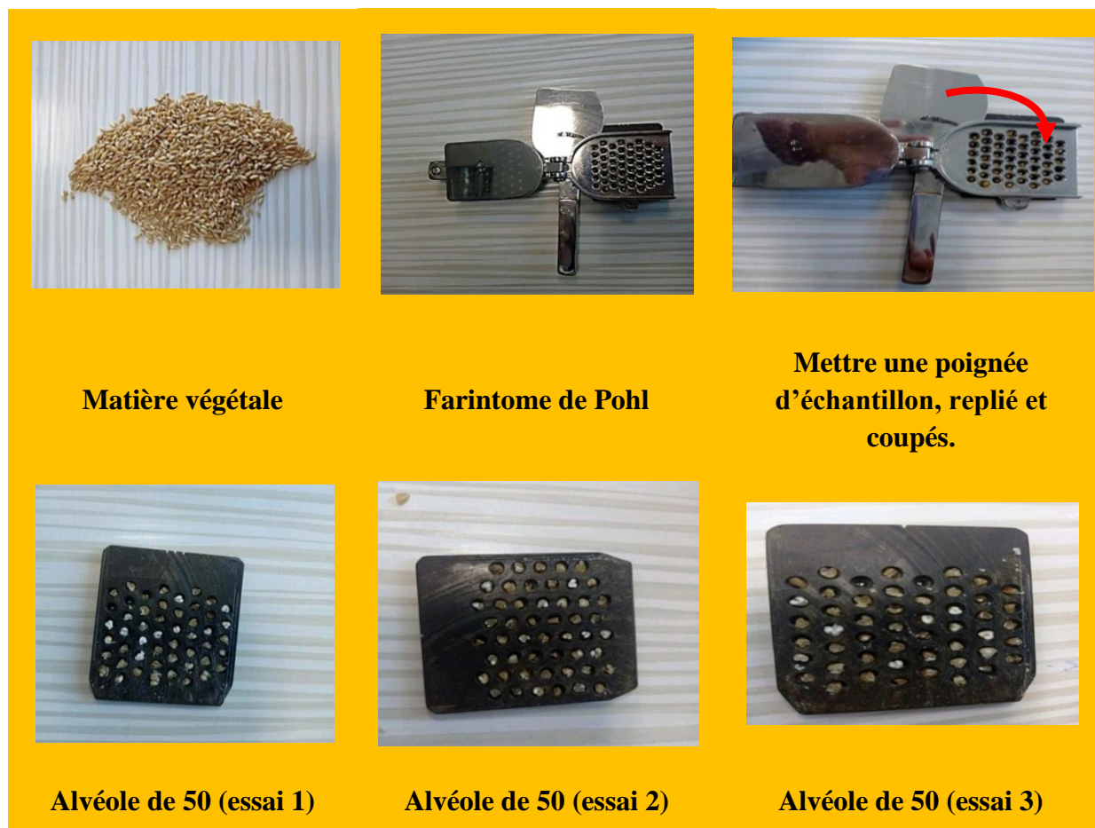
Figure E: Mode opératoire pour déterminer taux de mitadinage.
