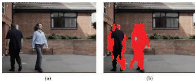
Figure 1.9 : la différenciation temporelle. (a) une scène avec deux objets en mouvement. (b) la différenciation échoue à détecter tous les pixels de l'objet à gauche puisqu'il est uniforme de couleur.les régions en mouvement sont marquées en rouge. [12]
