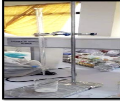
Figure 8 : Titrage de l'acidité par l'hydroxyde de sodium et phénophtaléine
