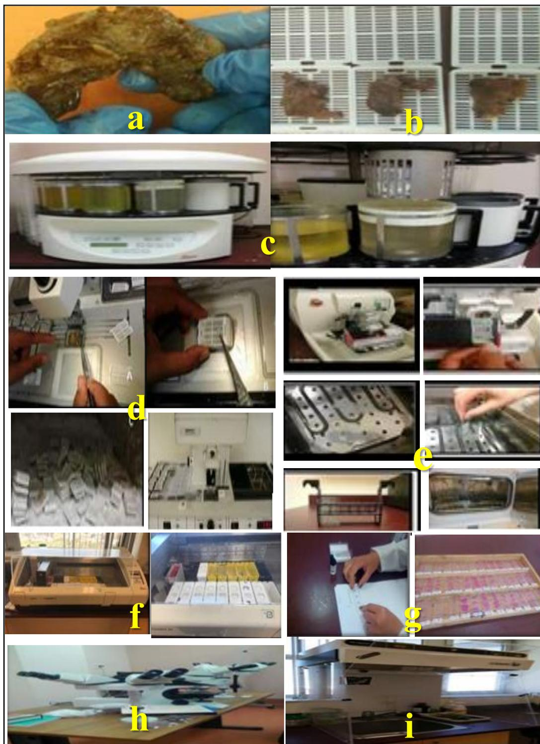
**Figure 8:** prélèvement des zones anormales et saines (a), emplacement des coupes dans des cassettes numérotées (b), déshydratation des coupes (c), inclusion dans la paraffine (d), réalisation des différentes étapes de la coupe (e), appareil de coloration (f), étiquetage et montage des lames (g), visualisation des lames sous microscope optique (h), préparation des prélèvements sous la Hôte (i).
