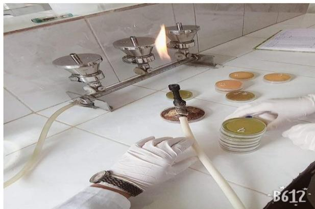
**Figure 6 :** Rampe de filtration.
