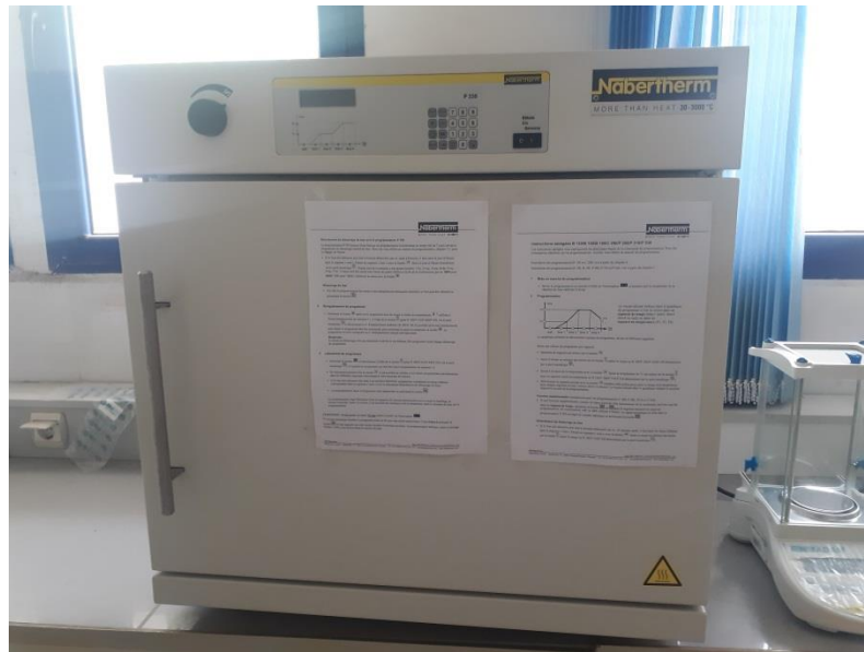
Figure III. 10 : Etuve de marque Nabertherm pouvant atteindre la température de 300 °C utilisée pour chauffer les plaques en acier.
