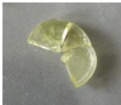
Figure III. 11 : Aspect du verre obtenu juste après trempe (avant recuit)
