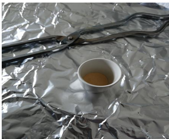
Figure III. 5 : Photographie du creuset en porcelaine contenant les différentes poudres de départ rebroyées et bien mélangées
