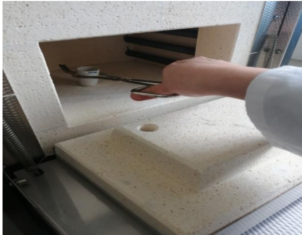
Figure III.6 : Placement du creuset dans la chambre du four à moufle lorsqu'il est à température ambiante
