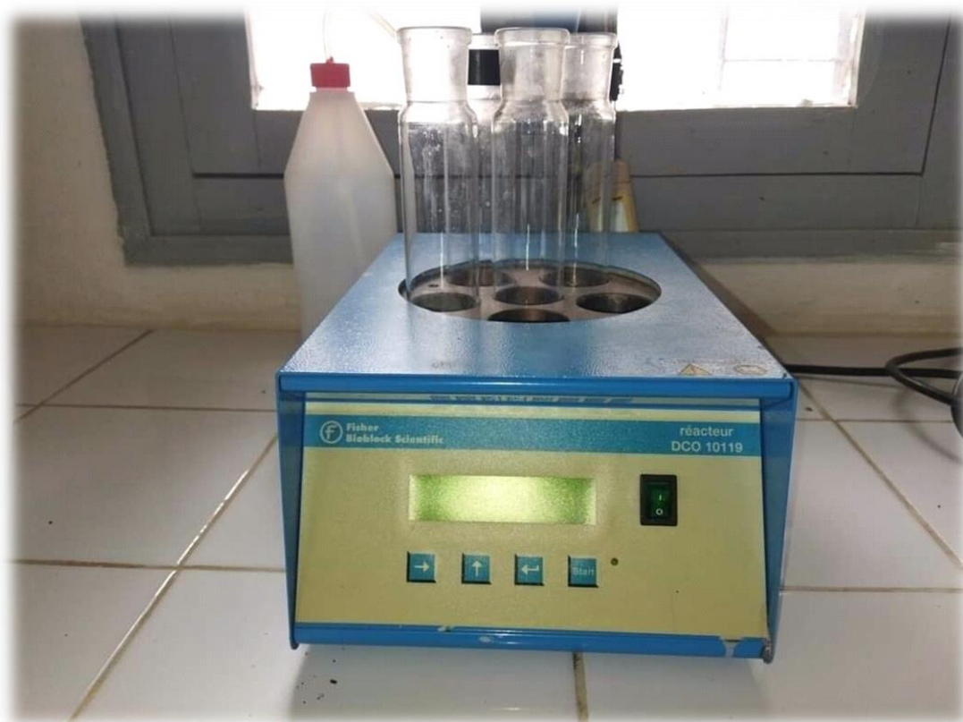
Figure.III.9. plaque chauffant avec tubes et réfrigérants
