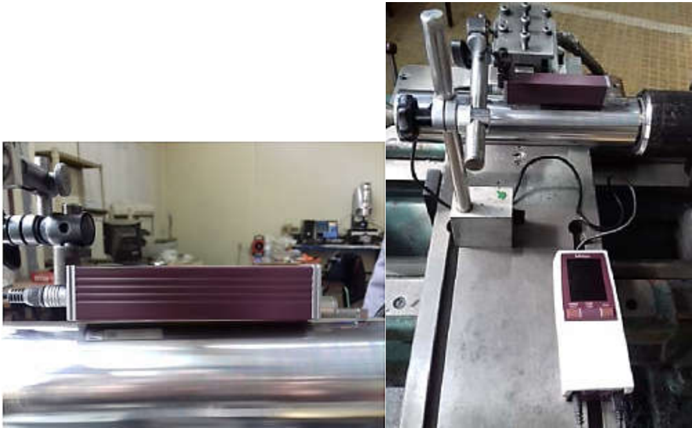
Figure II.7 Rugosimètre 2D en plein opération de mesure.
