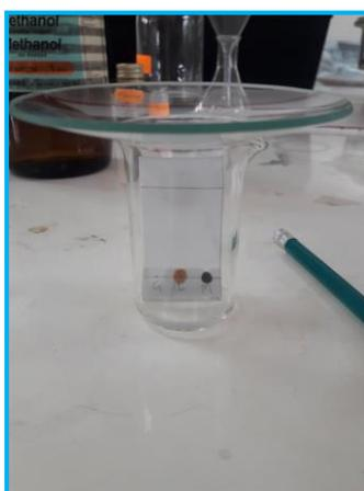
**Figure.IV.3 :** Identification de  $L_1$  sur la plaque CCM.
