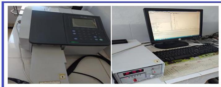
**Figure.III.3 :** Image photographique de spectrophotomètres UV-Visible Shimadzu model UV1800.
