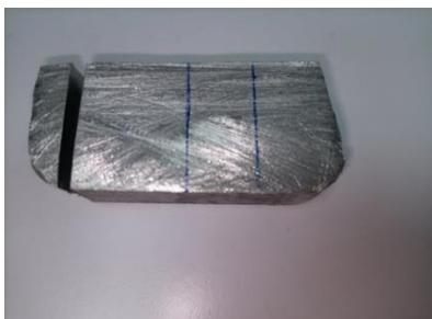
**Figure II.1** : Morceau du matériau découpé dans lingot.
