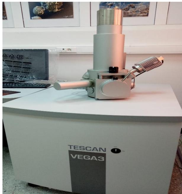
**FigureII.10** : Microscope électronique à balayage (MEB) de marque TESCAN VEGA3 utilisé.
