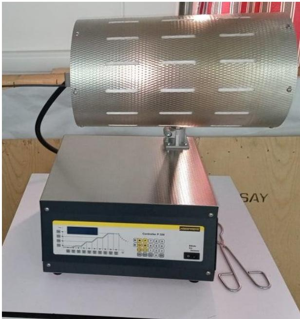
**Figure II.4** : Four tubulaire type Nabertherm utilisé pour les traitements thermiques.
