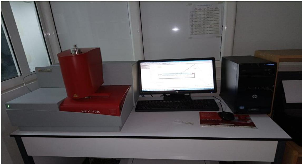
**Figure II.8 :** DSC utilisée de type LABSYS Evo de marque Setaram utilisée.
