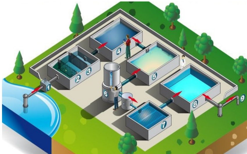
Figure I.III.1 : Chaîne de traitement de l'eau. (1- Captage, 2- Dégrillage, 3- Tamisage, 4- Floculation, décantation, 5- filtration, 6- désinfection, 7- traitement spécifique, 8- chloration, 9- stockage)
