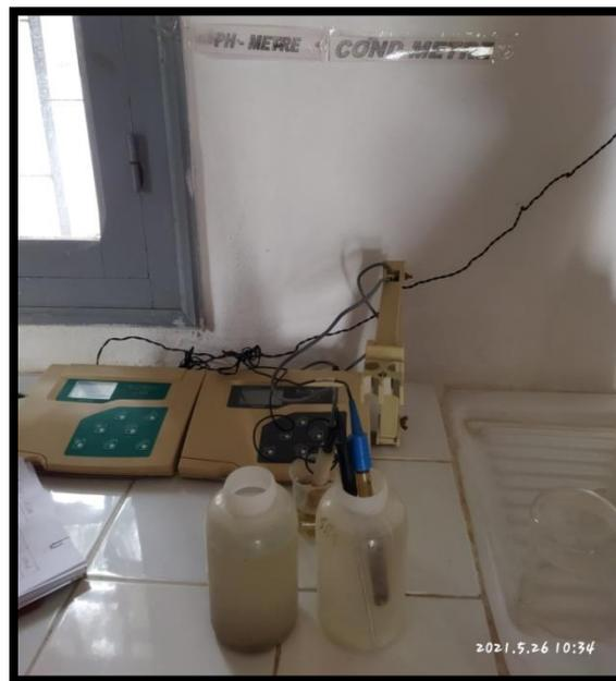
**Figure 3:** pH mètre, conductimètre.
