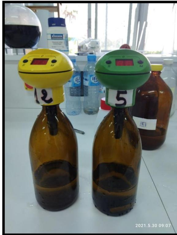
**Figure 7 :** Flacon colore pour DBO<sub>5</sub>.
