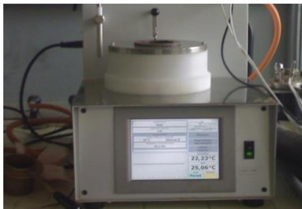
**Figure IV.2 :** Appareil ABEL pour détermination du point d'éclair.
