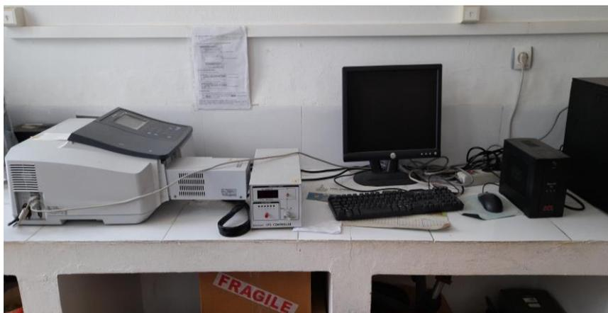
**Figure IV.14 :** Spectrophotomètre UV-Visible de type Shimadzu™ UV 1800 Spectrophotomètre.
