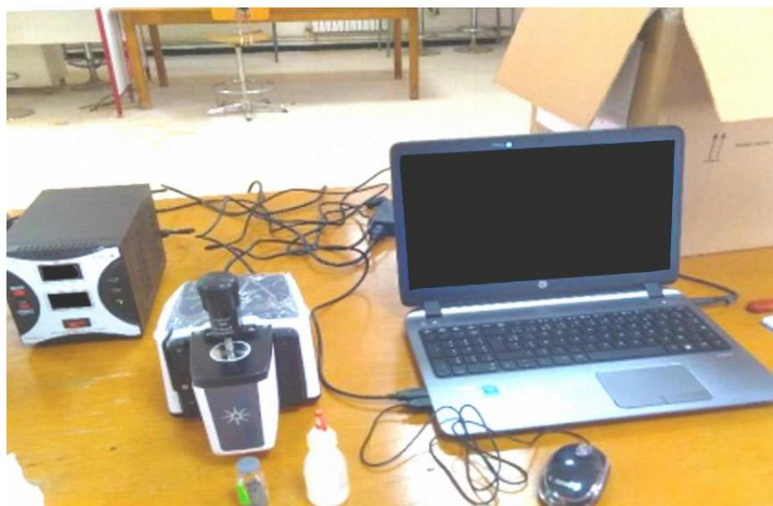
**Figure IV.15 :** Spectromètre ATR de type Agilent ATR Cary 630 FTIR.
