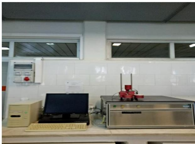
**Figure IV.8 :** Appareil de mesure du point de congélation.
