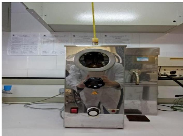
Figure IV.1 : Appareillage de distillation ASTM, échelle laboratoire.
