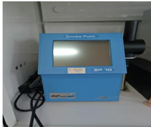
Figure IV.10 : Appareil mesurant le point de fumée.
