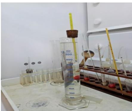
Figure IV.9 : Matériels pour mesure de densité.
