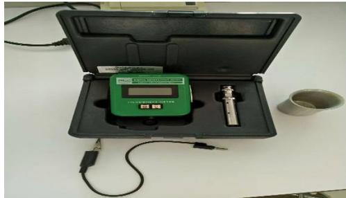
**Figure IV.7 :** Appareil de mesure de conductivité électrique.
