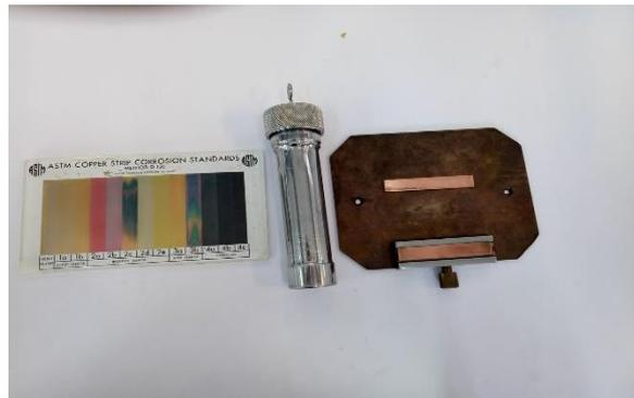
**Figure IV.5 :** Standard de corrosion de lame de cuivre.
