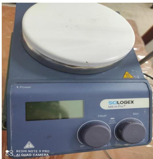
**Figure III.4 :** Agitateur magnétique à plaque chauffante MS-H-Pro Plus (SCIOGEX, USA) utilisé dans ce travail
