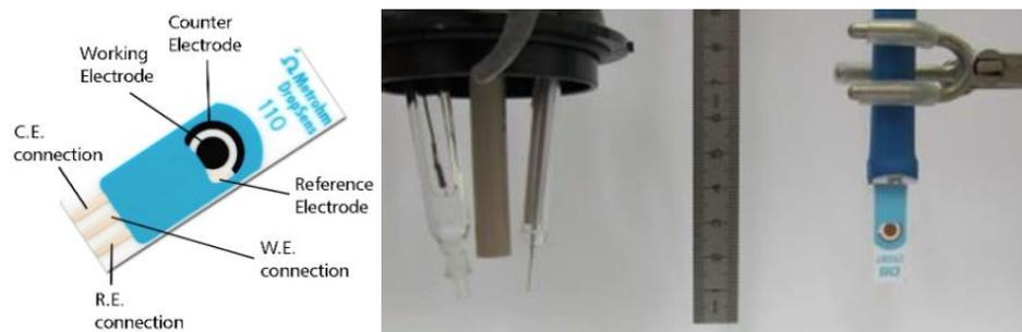
**Figure II.12 :** Photo d'une SPE (gauche) et comparatif d'encombrement entre un système classique à 3 électrodes et une SPE (droite) [91]
