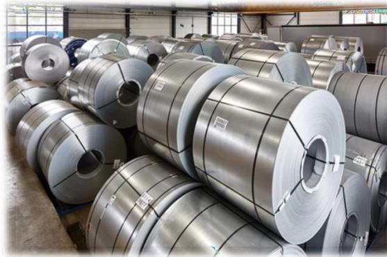
*Figure II.7 : Bobines Galvanisées*
