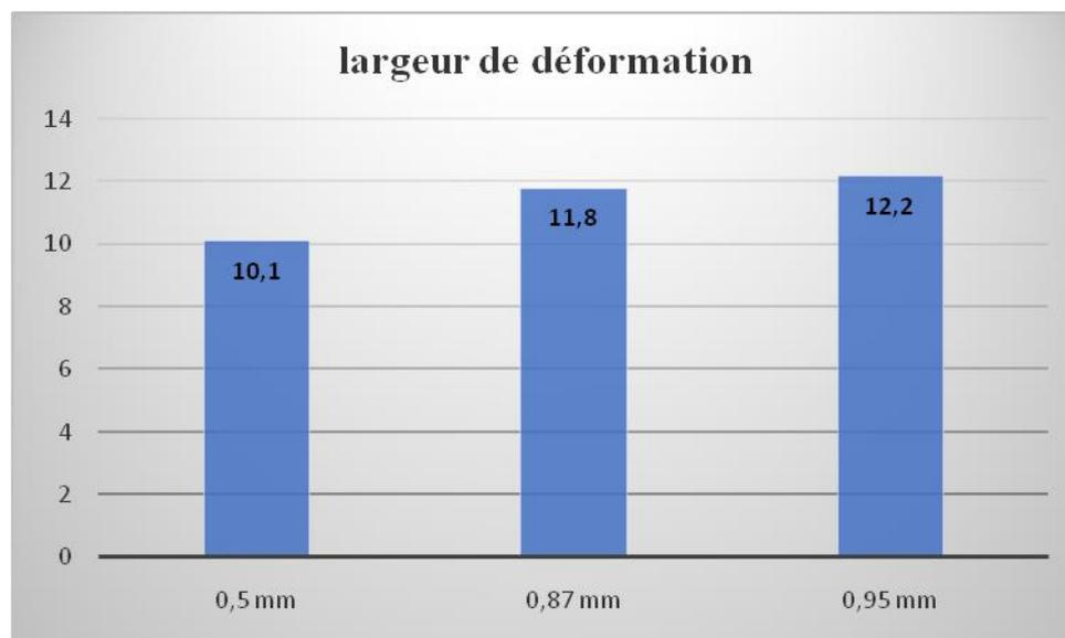
**Figure IV.4 :** : Histogramme de la largeur de déformation des trois tôles galvanisées
