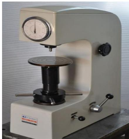
*Figure III.2: Duromètre HR-150A.*
