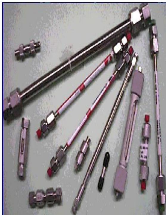
*Figure II.06 : Quelques types de colonnes pour HPLC [18].*
