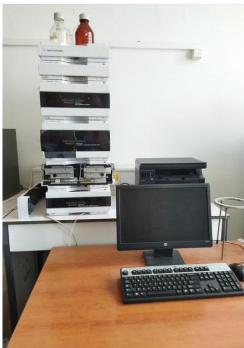
*Figure III.01: Appareil HPLC (Agilent série 1260 Infinity) utilisé. (Laboratoire de Chimie Appliquée, Université de Guelma).*
