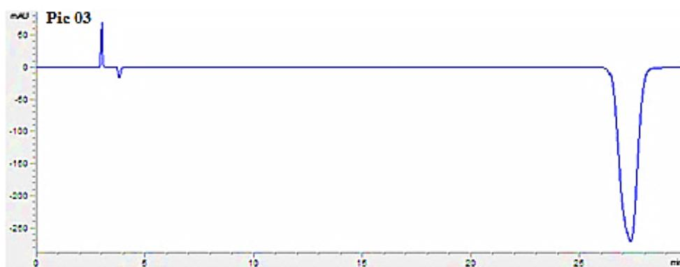
Figure IV.07 : Chromatogrammes des mélanges (Q+S) à différentes concentrations de Q (C, 2C, 4 C, 8 C, 12 C et 16 C).
