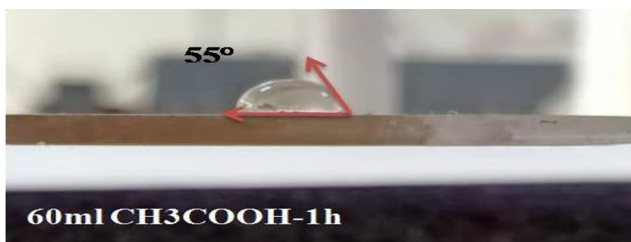
Figure III.30: L'angle de contact pour échantillon -04
