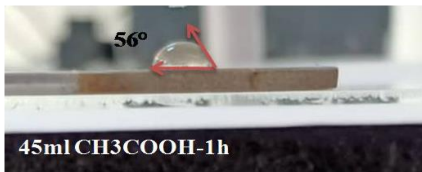
Figure.III.29: L'angle de contact pour échantillon-03
