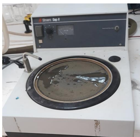
Figure III.1: Polisseuse mécanique utilisée pour préparation des échantillons
