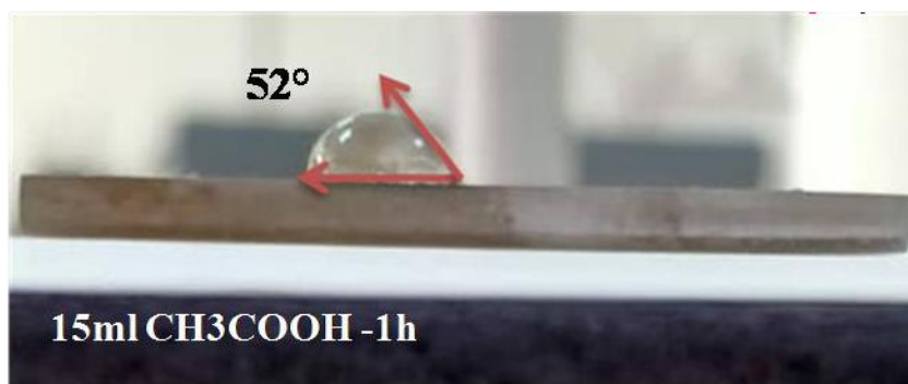
Figure III.27: L'angle de contact pour échantillon -01
