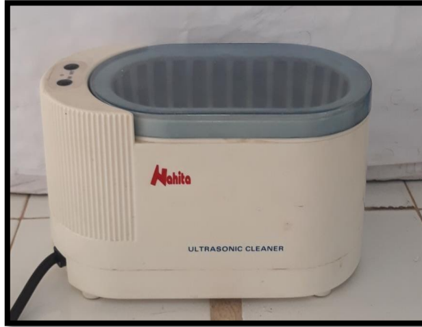
Figure III.3 : Bain ultrasonique pour le nettoyage des substrats
