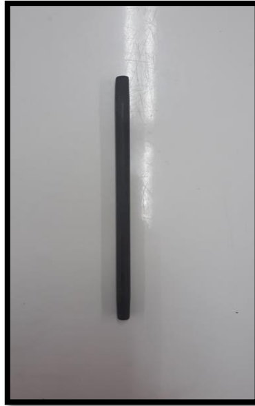
Figure III.7 : Photographie de l'électrode auxiliaire (graphite)
