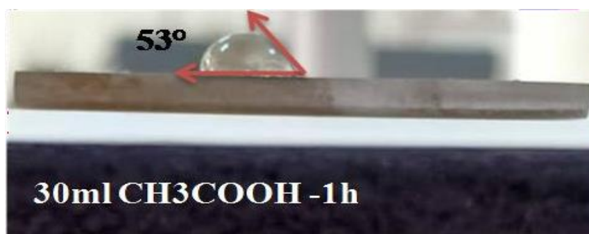
Figure III.28 : L'angle de contact pour échantillon -02
