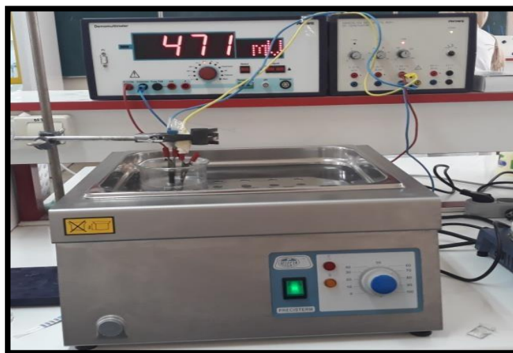
Figure III.4 : Photographie du dispositif expérimental utilisé pour l'électrodéposition de la couche de la couche de carbone
