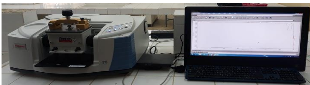
Figure III.12 : Le spectrophotomètre infrarouge (FTIR) utilisé.
