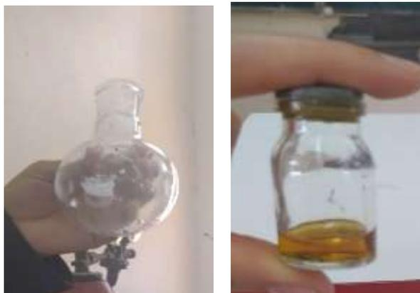
**Figure III-5 :** Aspect de l'huile extraire par l'hydrodistillation (gauche) et par extraction avec de l'éthanol (droite)
