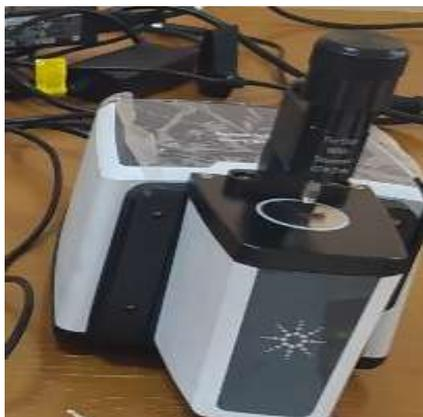
**Figure III-15- :** Spectromètre ATR de type Agilent Cary 630 FTIR.
