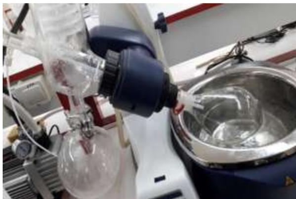
**Figure III-4- :** Montage de séparation du dichlorométhane par rotavap
