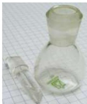
**Figure III-7-** : Pycnomètre de mesure de la densité
