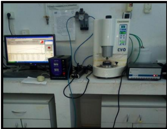
Figure IV. 10: Dispositif expérimental de l'étude rhéologique.
