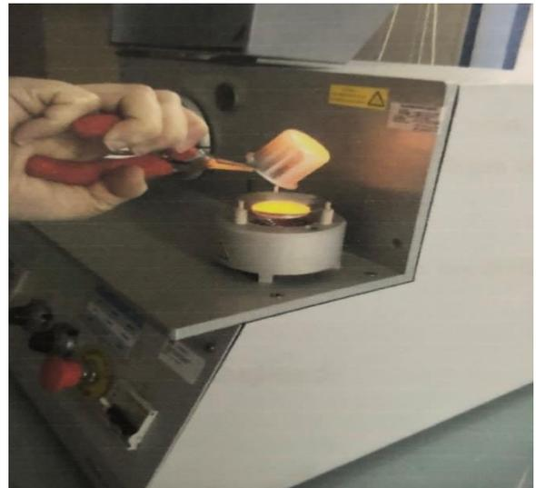
**Figure III. 6 :** Image de la mise en forme de perl
