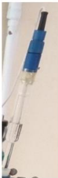
Figure III.7. : Photo de l'électrode de référence Ag/AgCl
