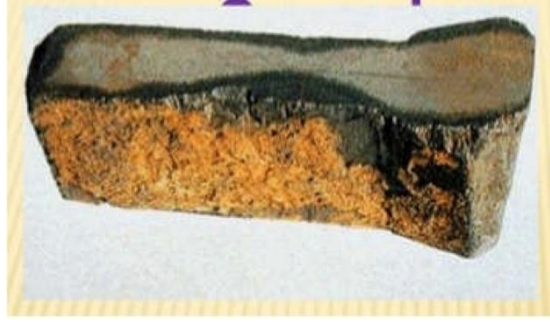
Figure I.7. La corrosion sélective [7]
