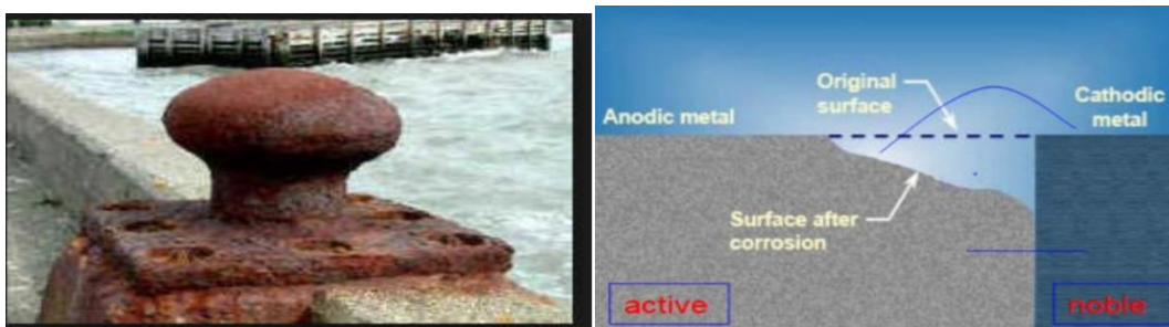
Figure I.3. La corrosion galvanique [9]
