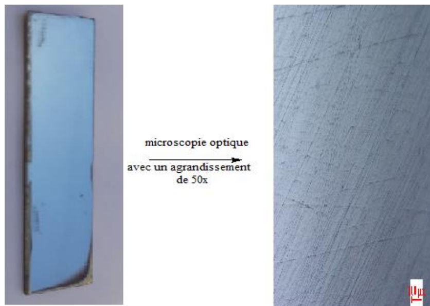
Figure IV.7. Photos de microscopie optique avec un agrandissement de 50x de l'électrode d'acier avant le revêtement en zinc
