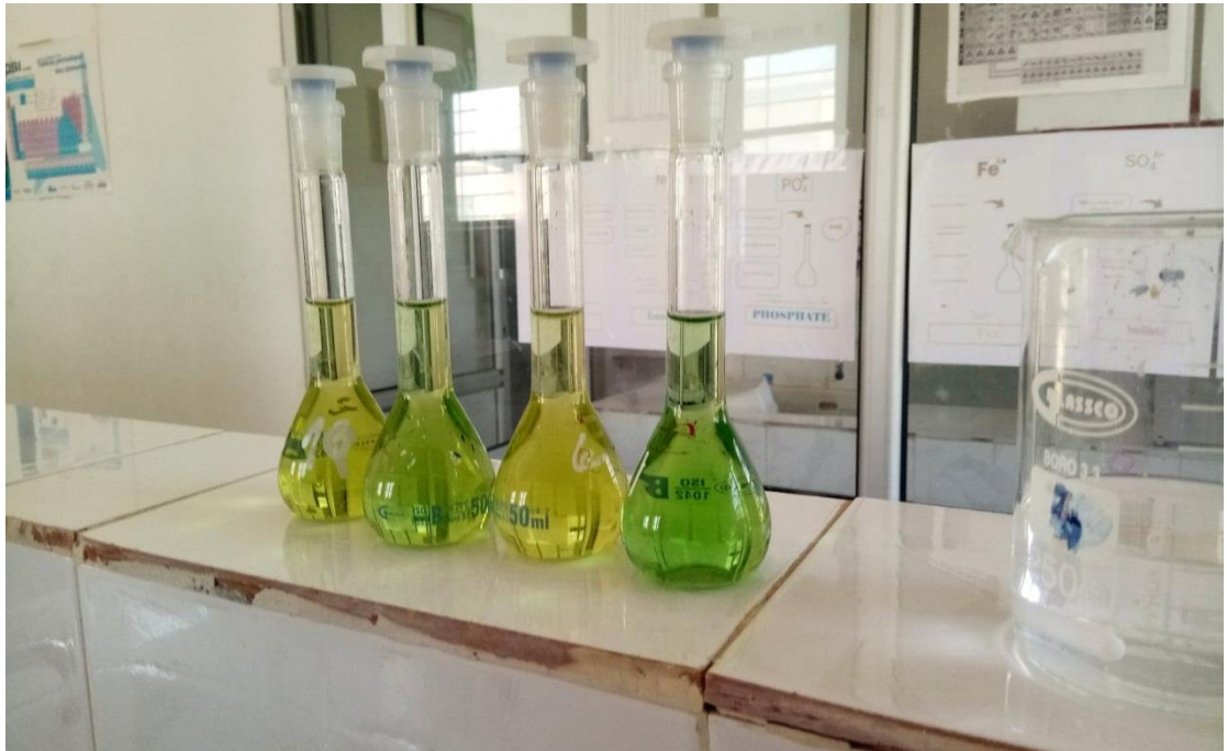
Figure 3.7 : Image représentant le dosage d'ammonium
