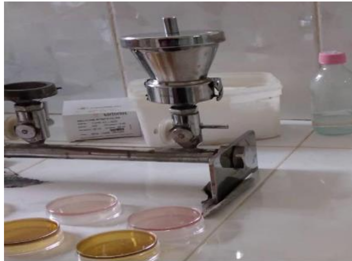
Figure 3.12 : la rampe de filtration
