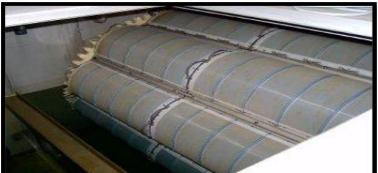
Figure 2.3 : Tambours filtrants (pour tamisage et micro-tamisage)
