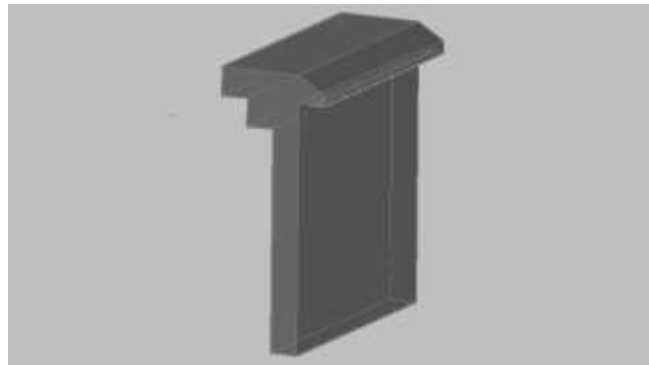
Figure III.1 : Schéma de l'acrotère.
