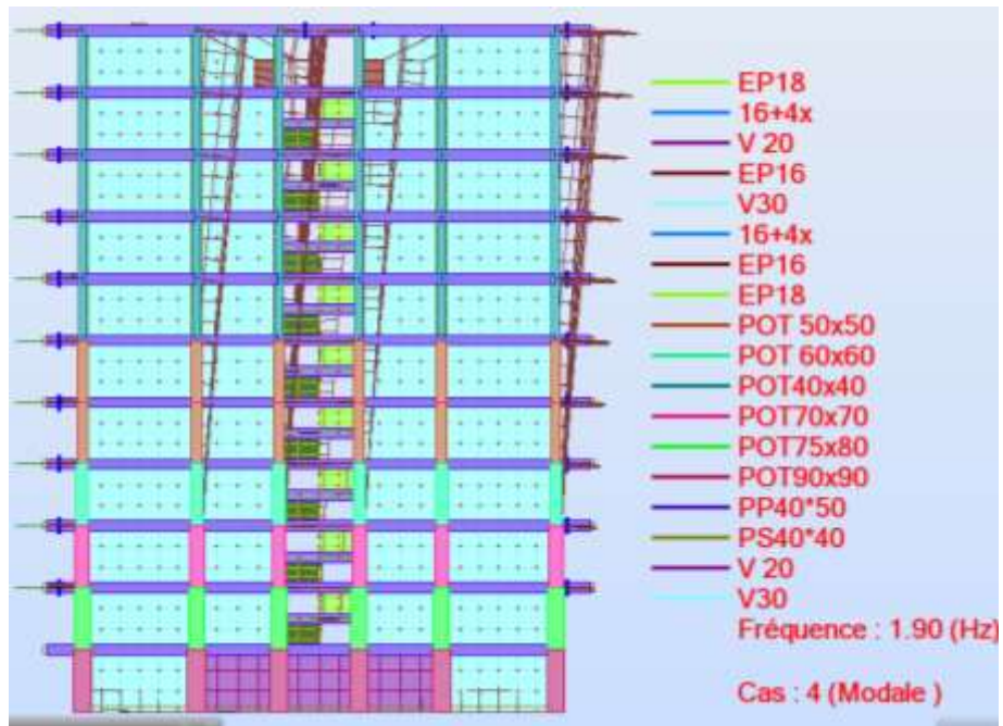
Figure VI.18 :2ème mode de déformation selon Y (3D)
