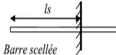
Figure III.3 : longueur de scellement
