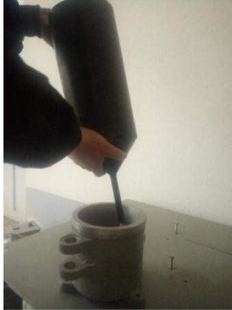
**Figure III.8:** Détermination de la masse volumique minimale.
