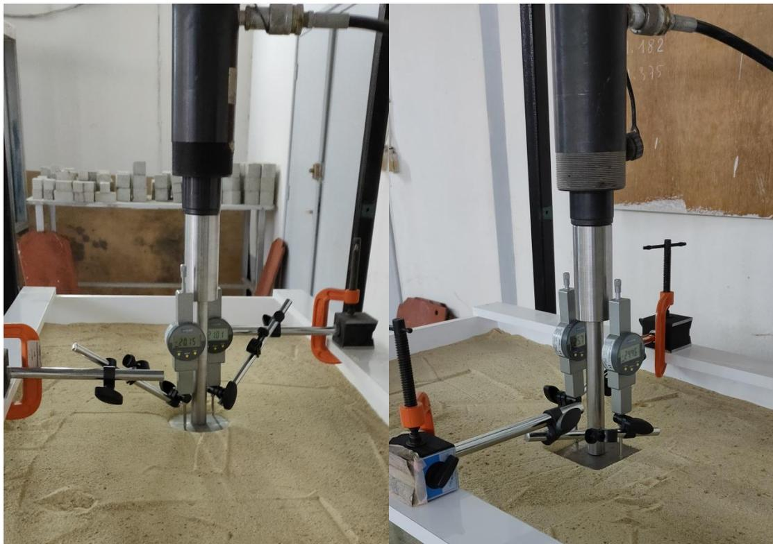
**Figure IV.5:** Dispositif expérimental utilisé dans les deux cas de semelles.
