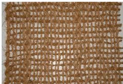
**Figure II.1 :** Géotextile tricoté.
