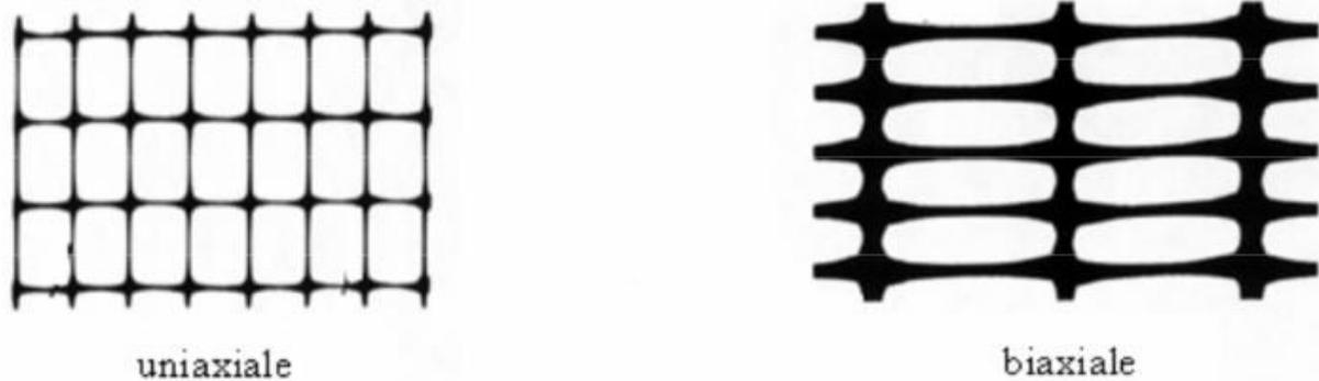
**Figure II.3.** Géogrilles uniaxiale et biaxiale.
