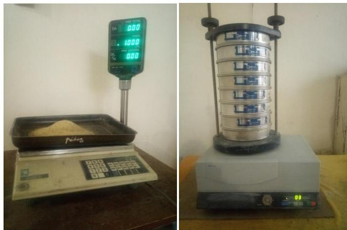
**Figure III.5:** Analyse granulométrique par tamisage.
