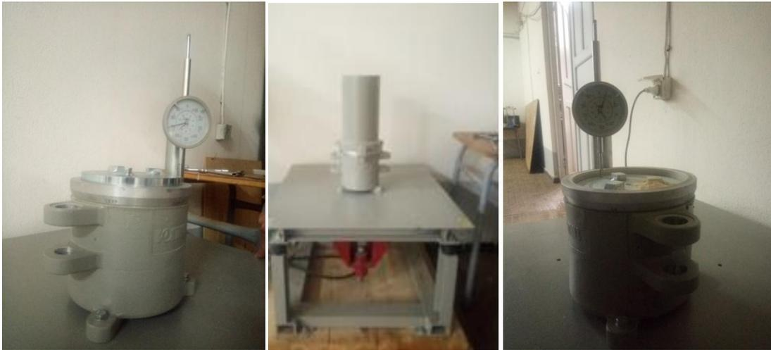
**Figure III.9:** Détermination de la masse volumique maximale.
